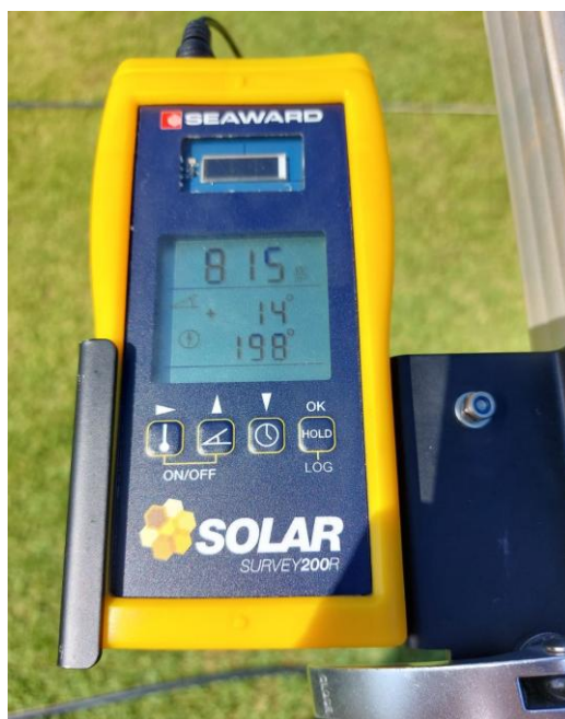
Figura 4.2 - Medição da inclinação dos painéis instalados na UHE Itumbiara Fonte: Dados da pesquisa (2020)
