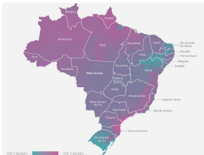
Figura 2.17 - LCOH para produção híbrida solar fotovoltaica e eólica em regiões selecionadas do Brasil no cenário de 2030 Fonte: Agora Industry (2024)
