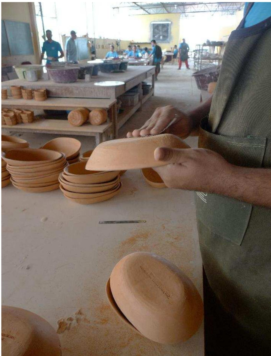
Fotografia 8 – Visão do lado esquerdo do galpão. Peça sendo “lixada”. Fonte: a autora, 14 de fevereiro de 2019.
