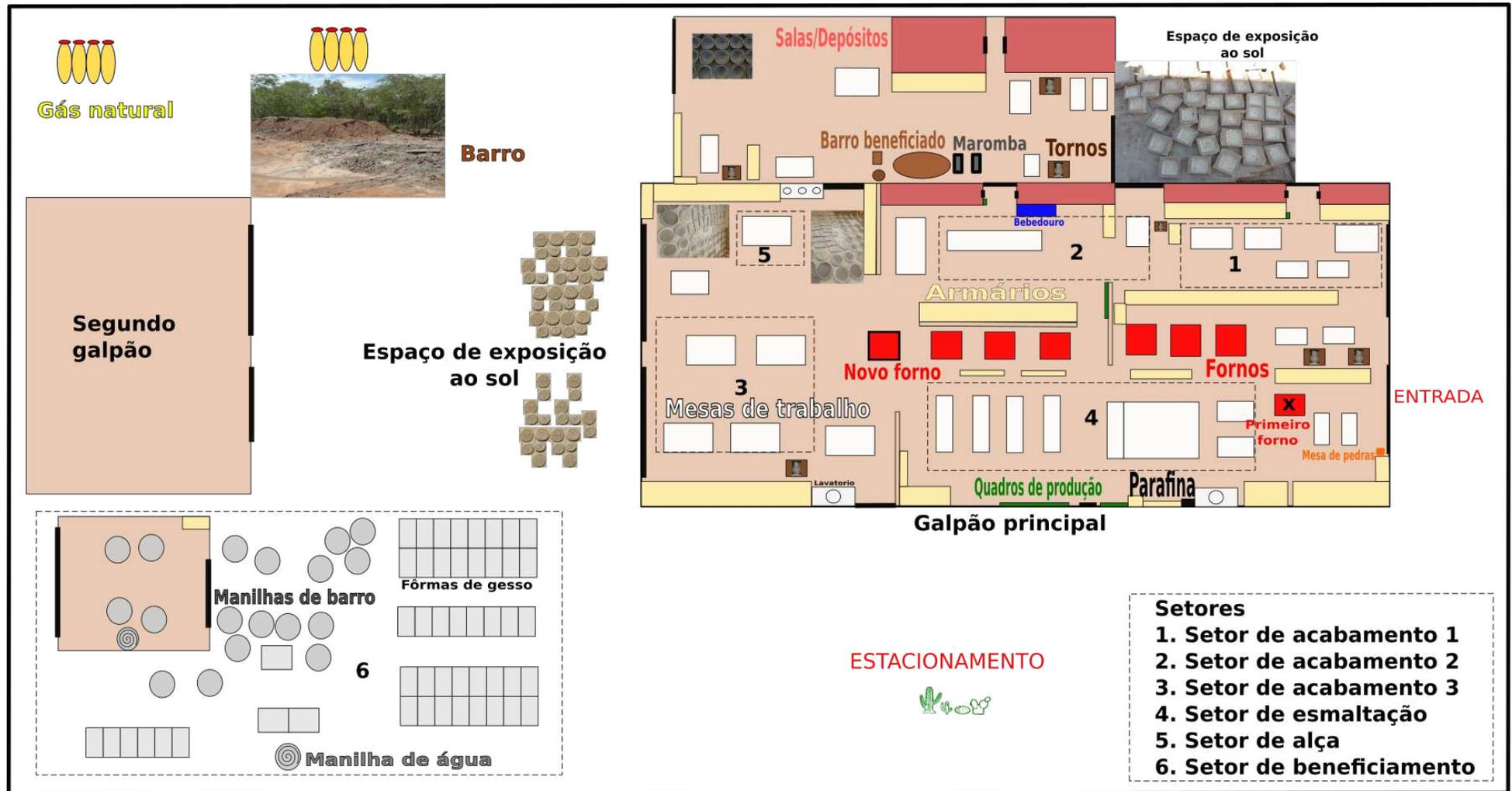
Figura 3 – Galpões de produção. Desenho de parte do espaço onde está a Cerâmica Artesanal Serra da Capivara. Divisão dos galpões de produção. Fonte: a autora.
