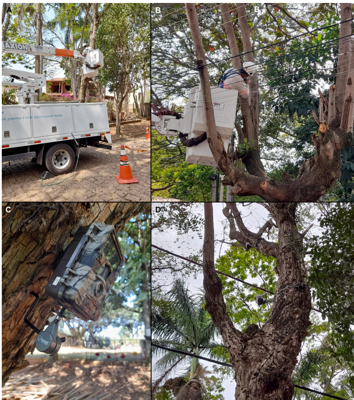
Figura 6. Instalação do equipamento. A) e B) técnicos da CPFL instalando as câmeras. C) Câmera com suporte móvel. D) Esquema de câmeras duplas, quando havia fios paralelos muito distantes. Fotos: Isabela Viotto Conti.
