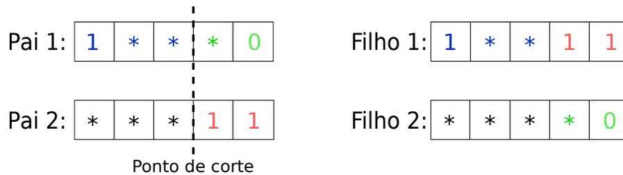
Figura 12 – Crossover de um ponto - esquemas.
