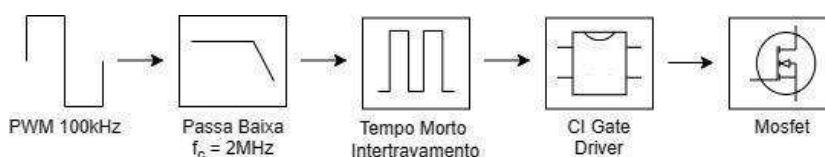
Figura 6 - Etapas no funcionamento do circuito de comando.
