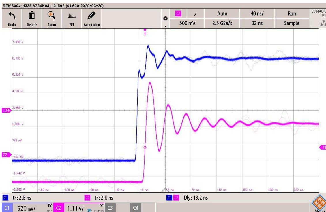
Figura A13. Sinal medido utilizando a ponteira isolada Rohde & Schwarz RT-ZHD 100MHz (curva azul [sinal de referência ponteira RT-ZP05S], curva rosa [sinal da ponteira isolada RT-ZHD]).
