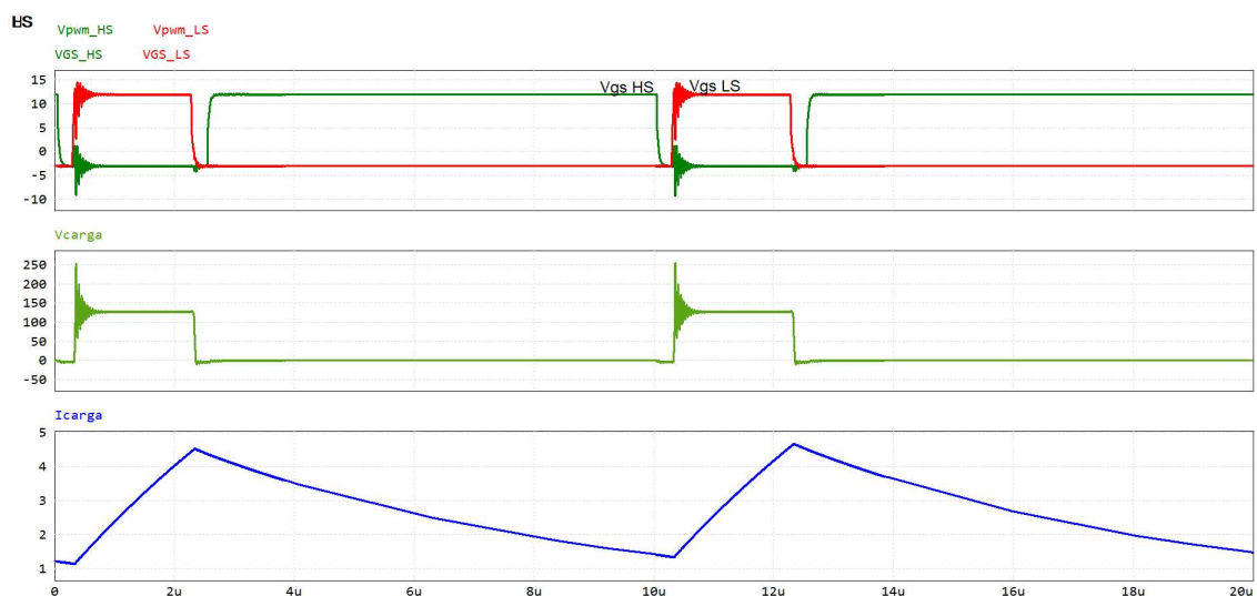
Figura 23 - Sinais de tensão e corrente cíclica em 25% na carga ( R_g = 3\Omega ).
