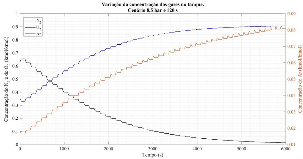
(a) Pureza dos gases no tanque de armazenamento após os leitos de adsorção, cenário de 8,5 bar e 120 segundos.
