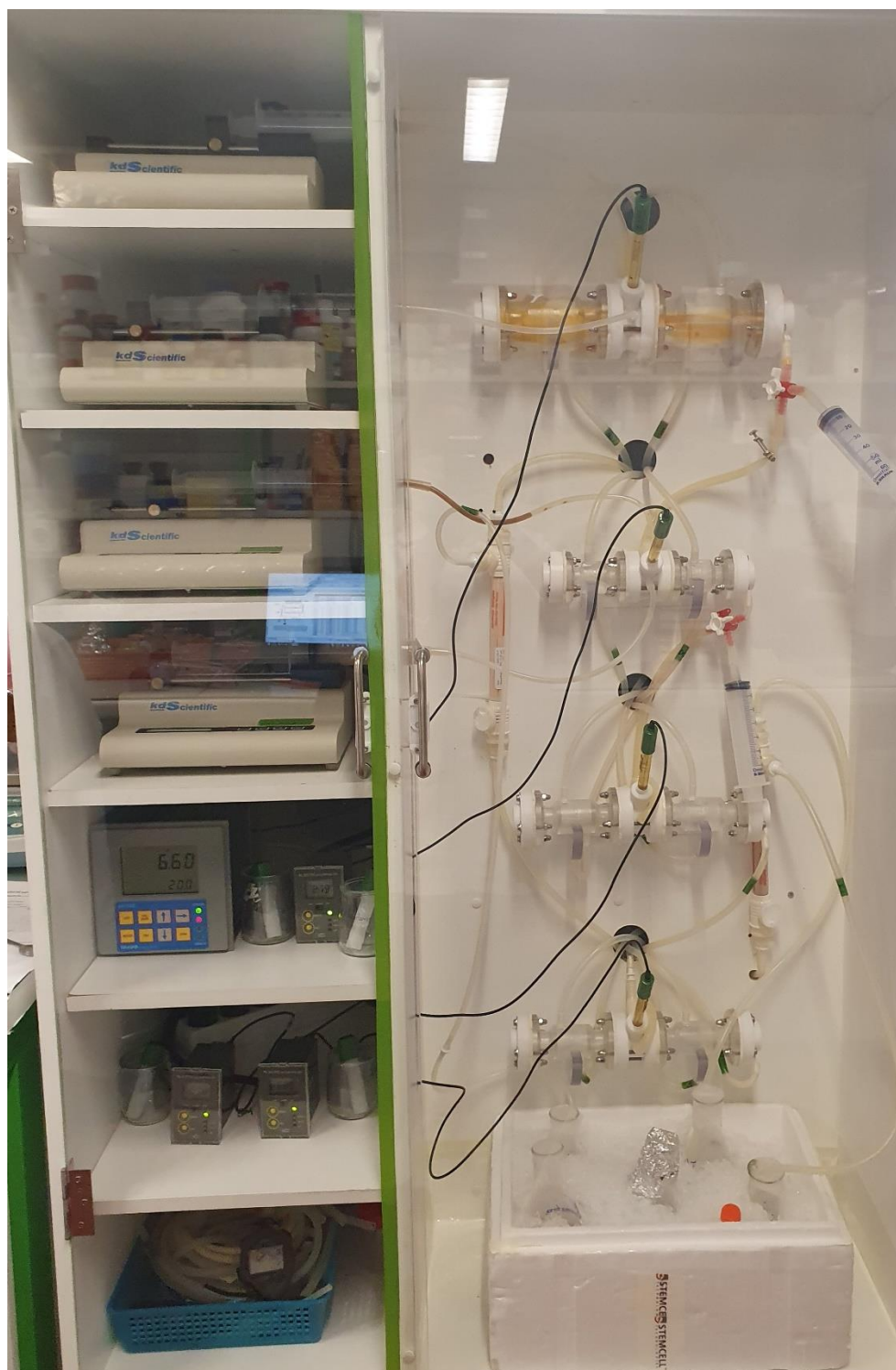
Figura 4: Sistema gastrointestinal dinâmico (DIVGIS) utilizado para os ensaios de digestibilidade in vitro .
