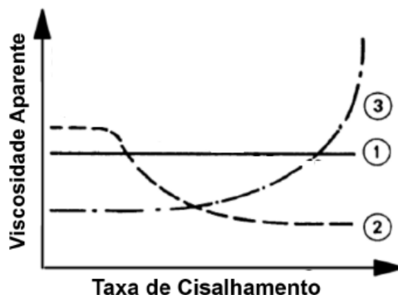
Figura A2. Perfis característicos das curvas de viscosidade em função da taxa de cisalhamento para materiais 1) Newtonianos 2) Pseudoplásticos 3) Dilatantes. Adaptado da referência 77.
