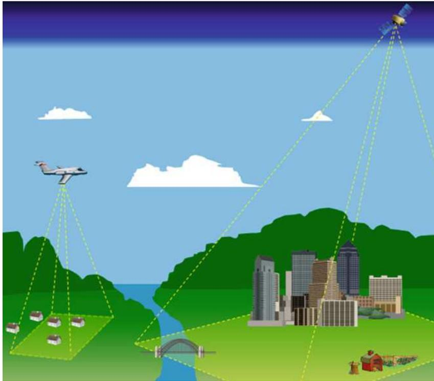
Figura 2.1: Normalmente, as medições de sensoriamento remoto são coletadas por instrumentos acoplados em aeronaves ou satélites em órbita terrestre que capturam e quantificam o sinal eletromagnético emanado da superfície e de seus objetos. Extraído de [35].
