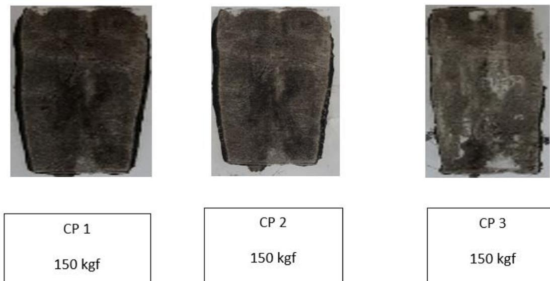
Áreas de contato impressas na compressão diametral dos corpos de prova 1, 2 e 3 comprimidos na força de 150 kgf.
