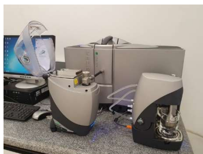
Figura 25: Analisador de Tamanho de Partículas por Difração à Laser, Mastersizer-3000, Esquerda: Via Seca, e Direita: Via úmida
