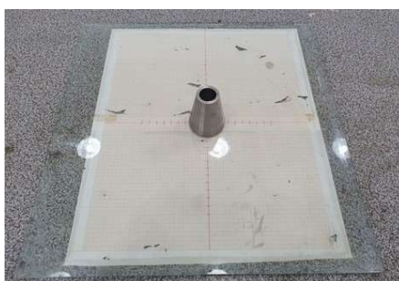
Figura 77: Placa de vidro e molde para ensaio de fluidez pelo método de Kanro
