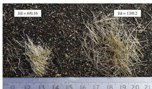
Figura 8: Esquerda: Fibras de aço retas com l_f = 6 mm e d_f = 0.16 mm. Direita: Fibras de aço retas com l_f = 13 mm e d_f = 0.2 mm (YU; SPIESZ; BROUWERS, 2014a)
