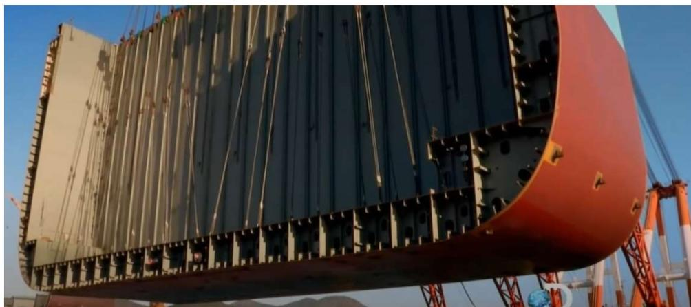
**Figura 1.1** – Casco de um navio Maersk Triple E
