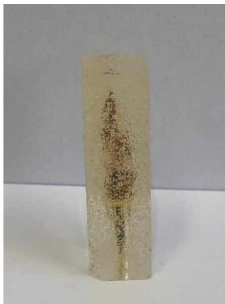
Figura 18 - Chaminé precipitada embutida em resina epóxi.
