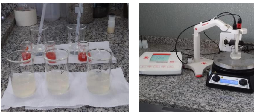
Figura 17. Montagem experimental de titulação para determinar a atividade enzimática da PME em polpa.
