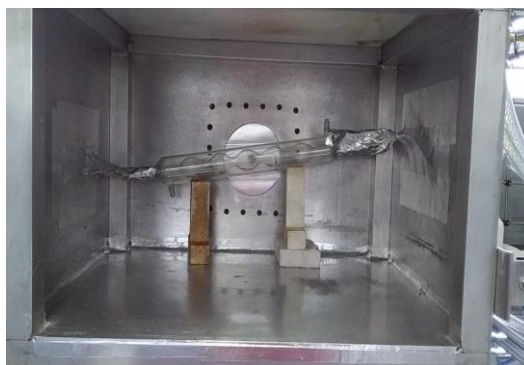
Figura 11. Disposição do condensador de vidro no interior do forno de micro-ondas.
