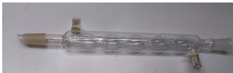
Figura 10. Condensador Allihn de bolhas como recipiente acondicionador da polpa e circulação de fluido de arrefecimento.
