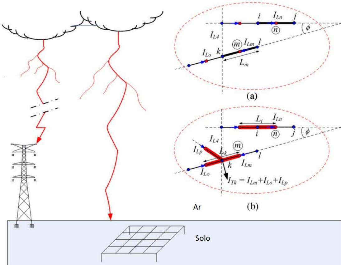
Figura 4.2 – Configuração dos elementos nos meios, (a) Elementos do primeiro grupo. (b) elementos do segundo grupo, Fonte: (Yutthagowith, Ametani, Nagaoka, & Baba, 2011), adaptado
