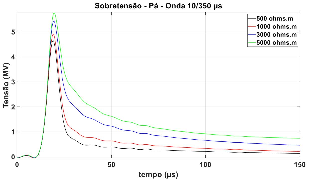
Figura 6.3.1.5 – Sobretensão na pá, onda 10/350  $\mu\text{s}$ , fonte: autor
