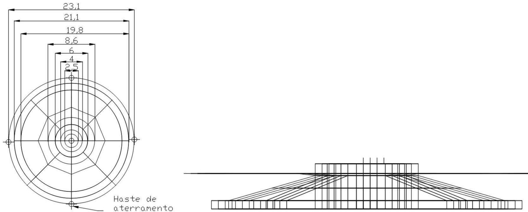
Figura 5.2 – Aterramento de um aerogerador com as dimensões, anéis com diâmetro 23,1 e 8,6 metros, são de cobre, demais aço, cotas em metros, profundidade da base de 3,15 metros, fonte: autor
