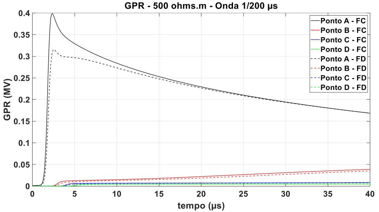
Figura 6.2.2.1 – GPR onda 1/200  $\mu$ s – Solo de 500  $\Omega$ .m, fonte: autor
