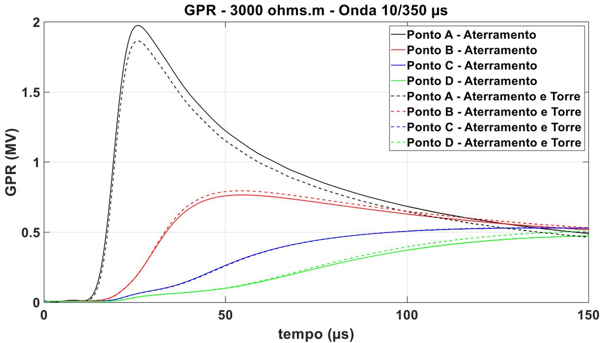
Figura 6.3.1.3 – GPR Onda 10/350  $\mu$ s, resistividade 3.000  $\Omega$ .m, fonte: autor
