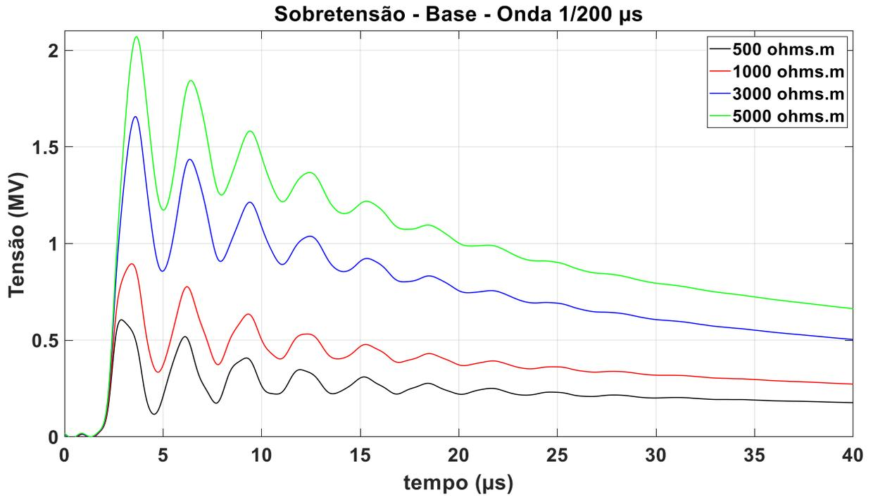
Figura 6.3.2.7 – Sobretensão na base, onda 1/200  $\mu$ s, fonte: autor
