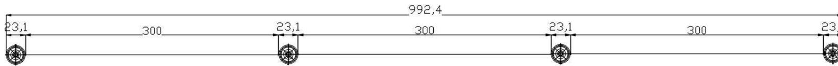
Figura 5.1 – Sistema de Aterramento de quatro aerogeradores interligados, cotas em metros, fonte: Autor
