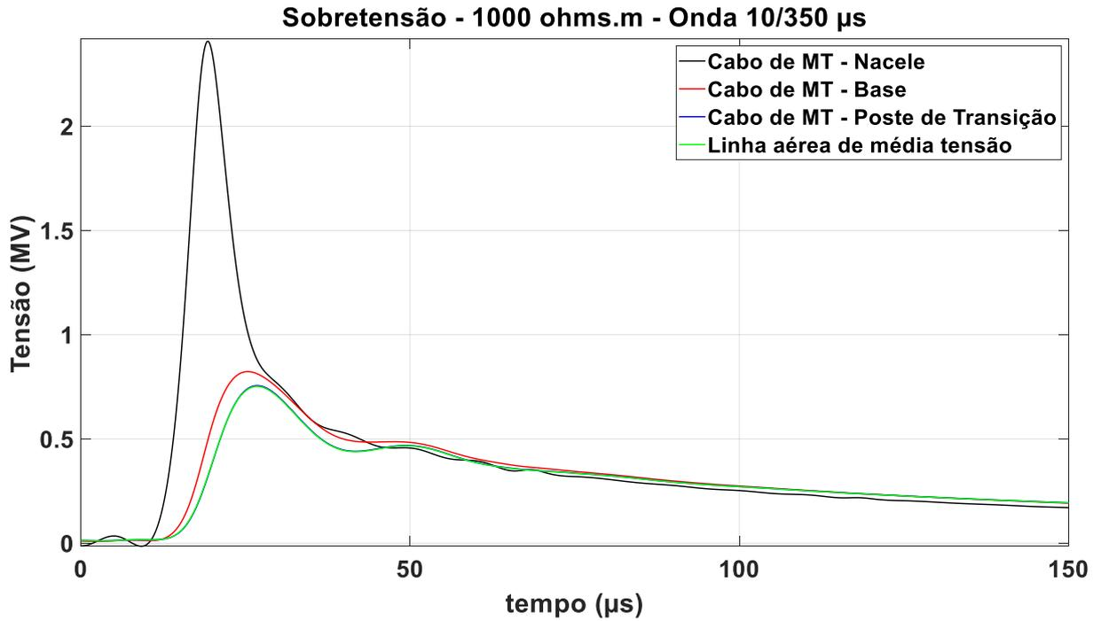
Figura 6.4.1.2 – Sobretensão onda 10/350  $\mu$ s, solo de 1.000  $\Omega$ .m, fonte: autor
