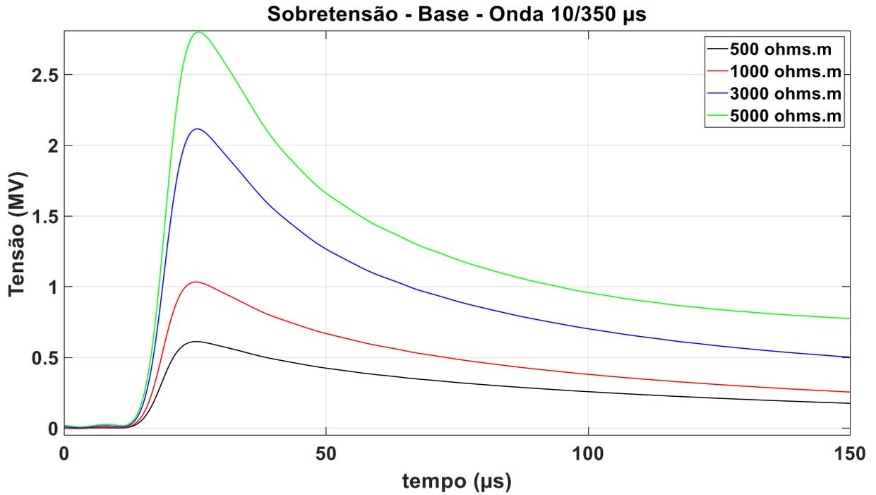
Figura 6.3.1.7 – Sobretensão na base, onda 10/350  $\mu$ s, fonte: autor
