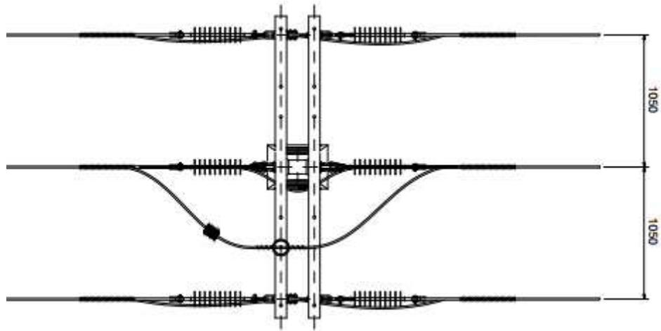
Figura 5.8 – Rede de média tensão 34,5kV, vista superior, cotas em milímetros, fonte: autor
