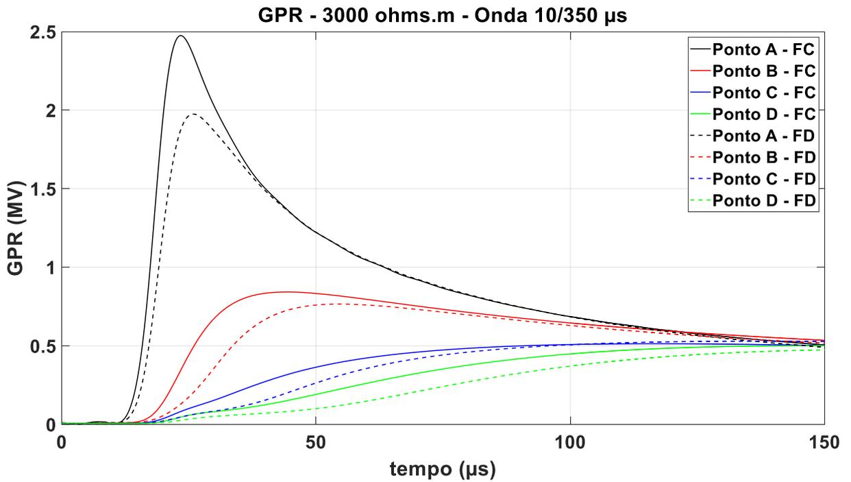
Figura 6.2.1.3 – GPR onda 10/350  $\mu$ s – Solo de 3.000  $\Omega$ .m, fonte: autor
