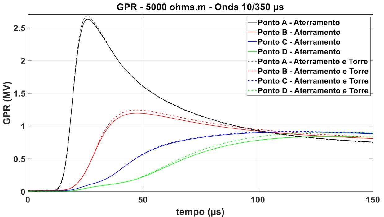
Figura 6.3.1.4 – GPR Onda 10/350  $\mu$ s, resistividade 5.000  $\Omega$ .m, fonte: autor
