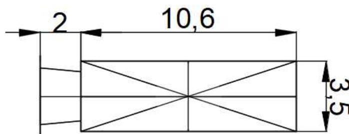
Figura 5.4 – Vista superior da Nacele e eixo da turbina, cotas em metros, Fonte: Autor
