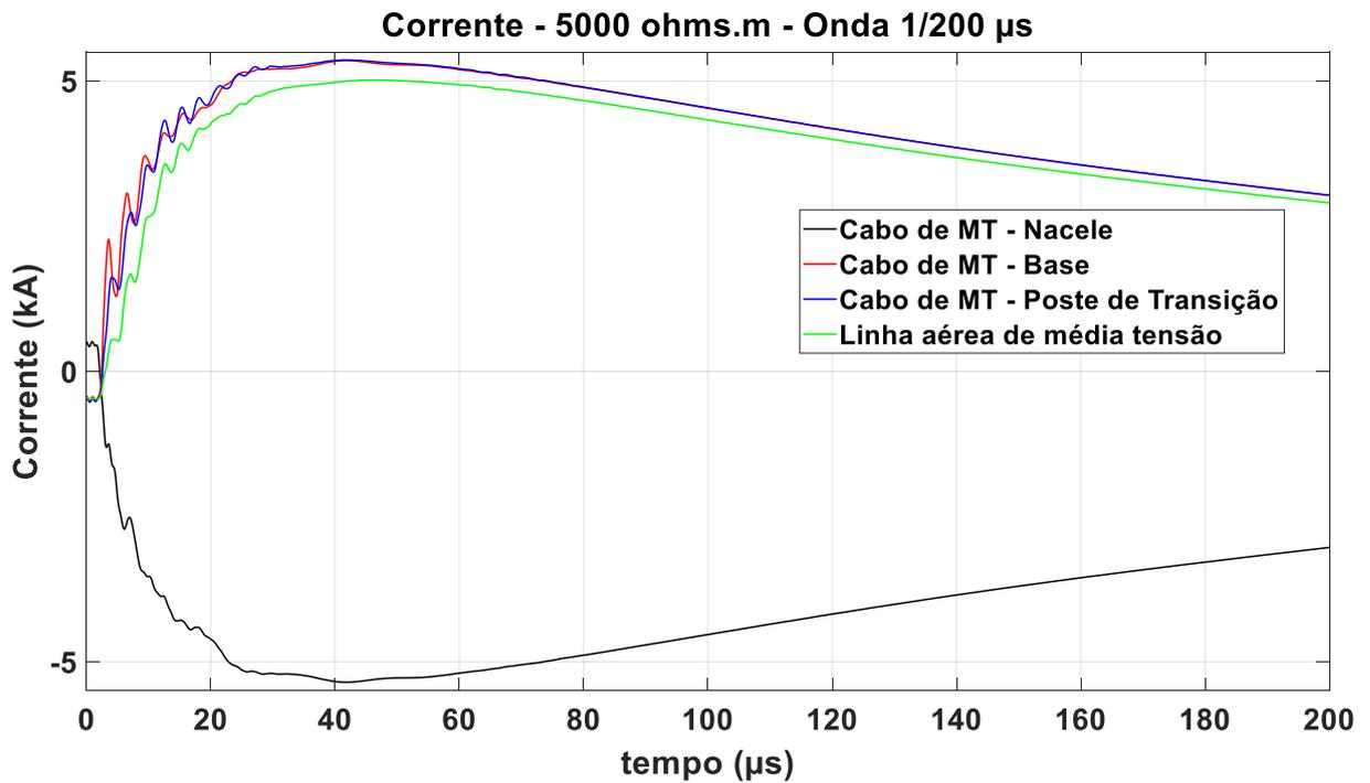
Figura 6.4.2.3 – Correntes onda 1/200  $\mu$ s, solo de 5.000  $\Omega$ .m, fonte: autor
