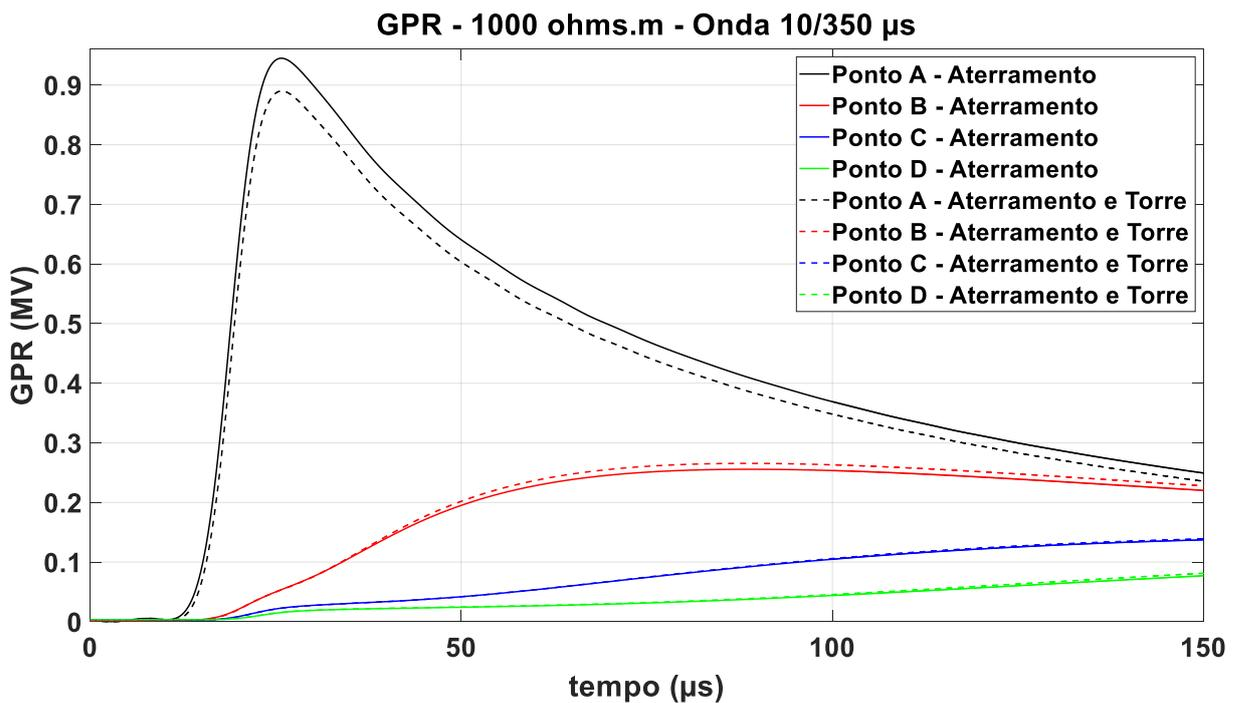
Figura 6.3.1.2 – GPR Onda 10/350  $\mu$ s, resistividade 1.000  $\Omega$ .m, fonte: autor
