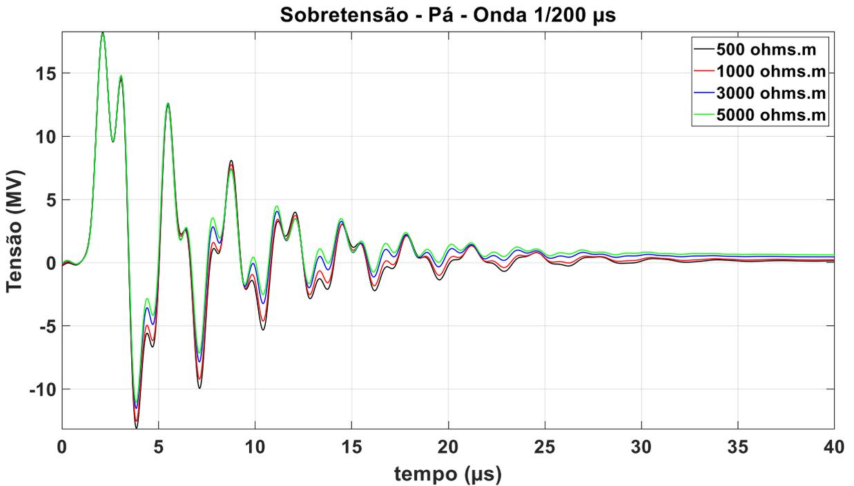
Figura 6.3.2.5 – Sobretensão na pá, onda 1/200  $\mu$ s, fonte: autor
