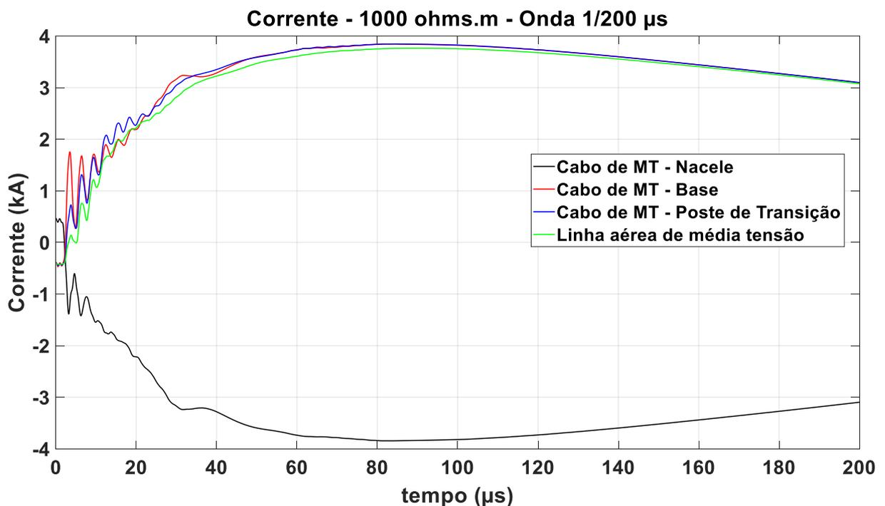
Figura 6.4.2.1 – Correntes onda 1/200  $\mu$ s, solo de 1.000  $\Omega$ .m, fonte: autor
