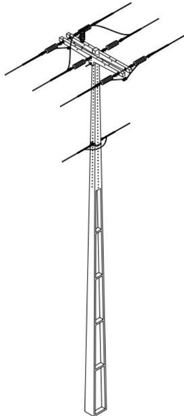
Figura 5.9 – Rede de média tensão 34,5kV, perspectiva, fonte: autor
