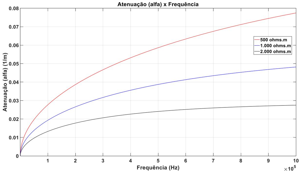
Figura 2.6 – Atenuação (alfa), parcela real x frequência, para três tipos de resistividades de solo, 500, 1.000 e 2.000  $\Omega.m$ , fonte: Autor.
