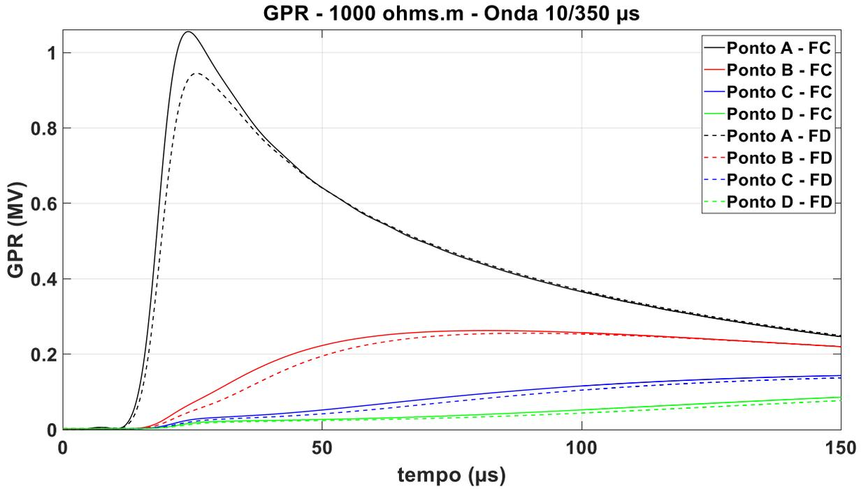
Figura 6.2.1.2 – GPR onda 10/350  $\mu$ s – Solo de 1.000  $\Omega$ .m, fonte: autor
