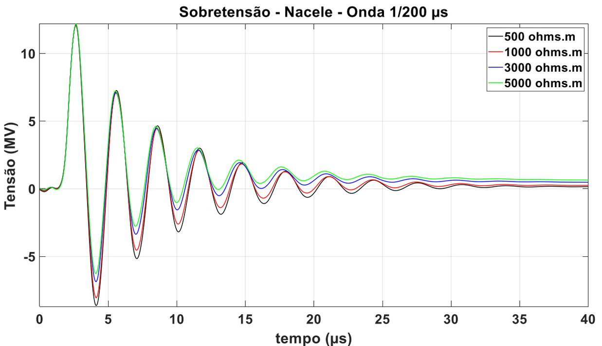
Figura 6.3.2.6 – Sobretensão na nacele, onda 1/200  $\mu$ s, fonte: autor
