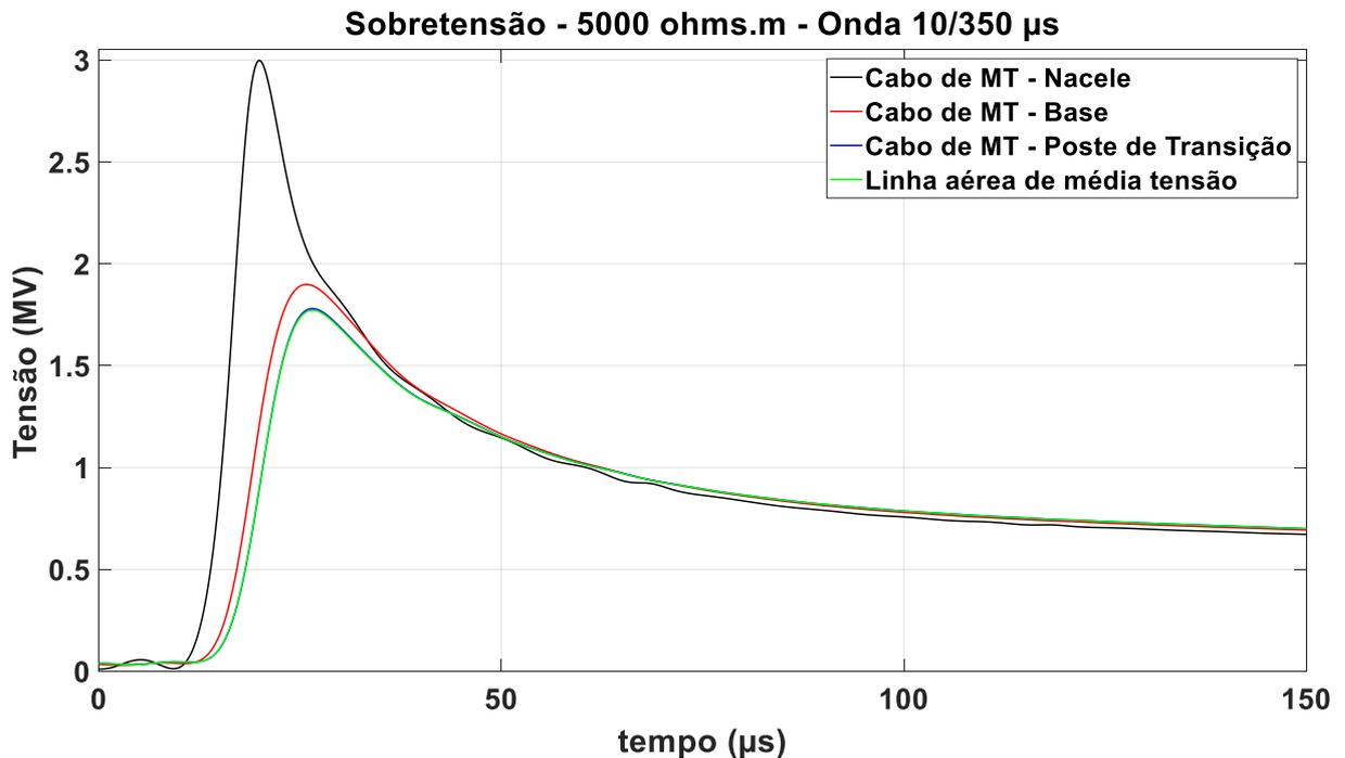
Figura 6.4.1.4 – Sobretensão onda 10/350  $\mu$ s, solo de 5.000  $\Omega$ .m, fonte: autor
