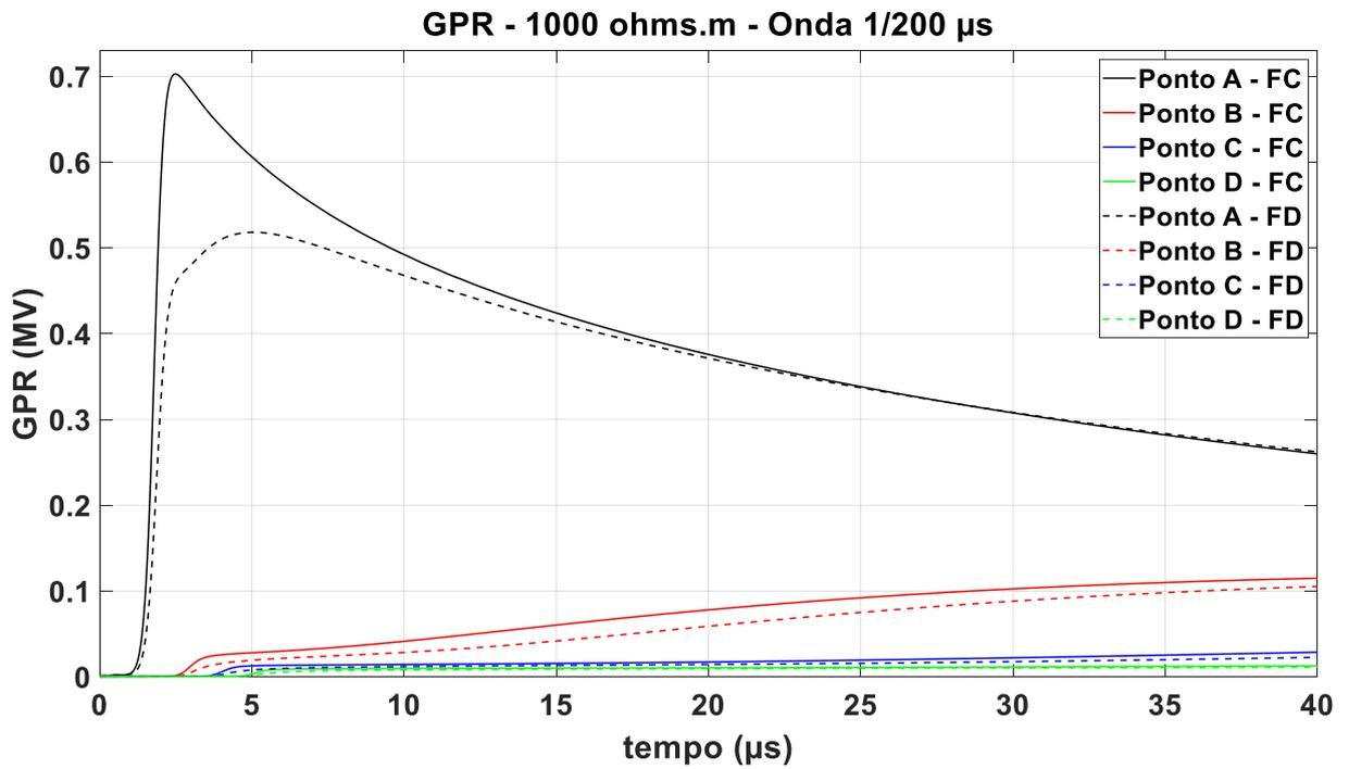
Figura 6.2.2.2 – GPR onda 1/200  $\mu$ s – Solo de 1.000  $\Omega$ .m, fonte: autor
