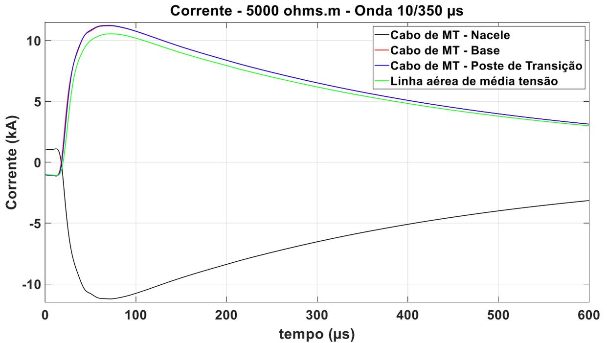
Figura 6.4.1.3 – Correntes ondas 10/350  $\mu$ s, solo de 5.000  $\Omega$ .m, fonte: autor
