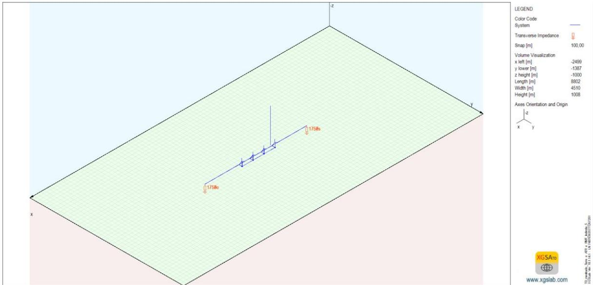
Figura 6.5.1 – Aterramentos interligados com rede de média tensão, descarga próxima a rede de média tensão, fonte: autor
