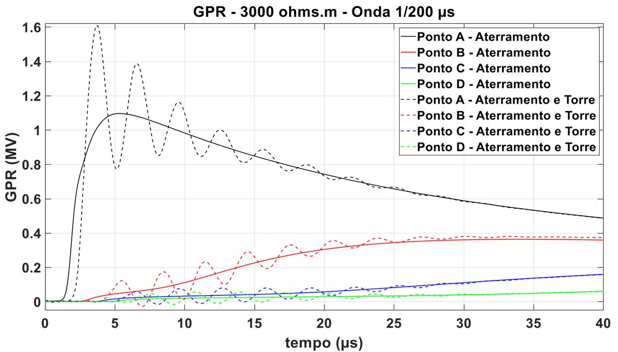
Figura 6.3.2.3 – GPR Onda 1/200  $\mu$ s, resistividade 3.000  $\Omega$ .m, fonte: autor
