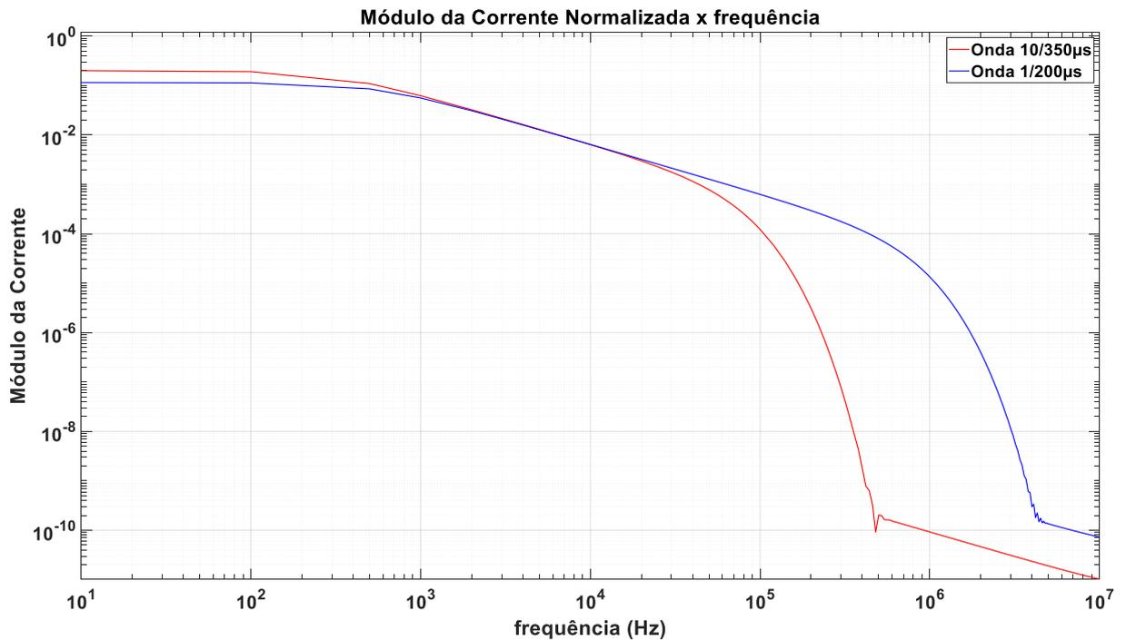
Figura 2.4 – Módulo das correntes normalizadas x frequência, fonte: Autor
