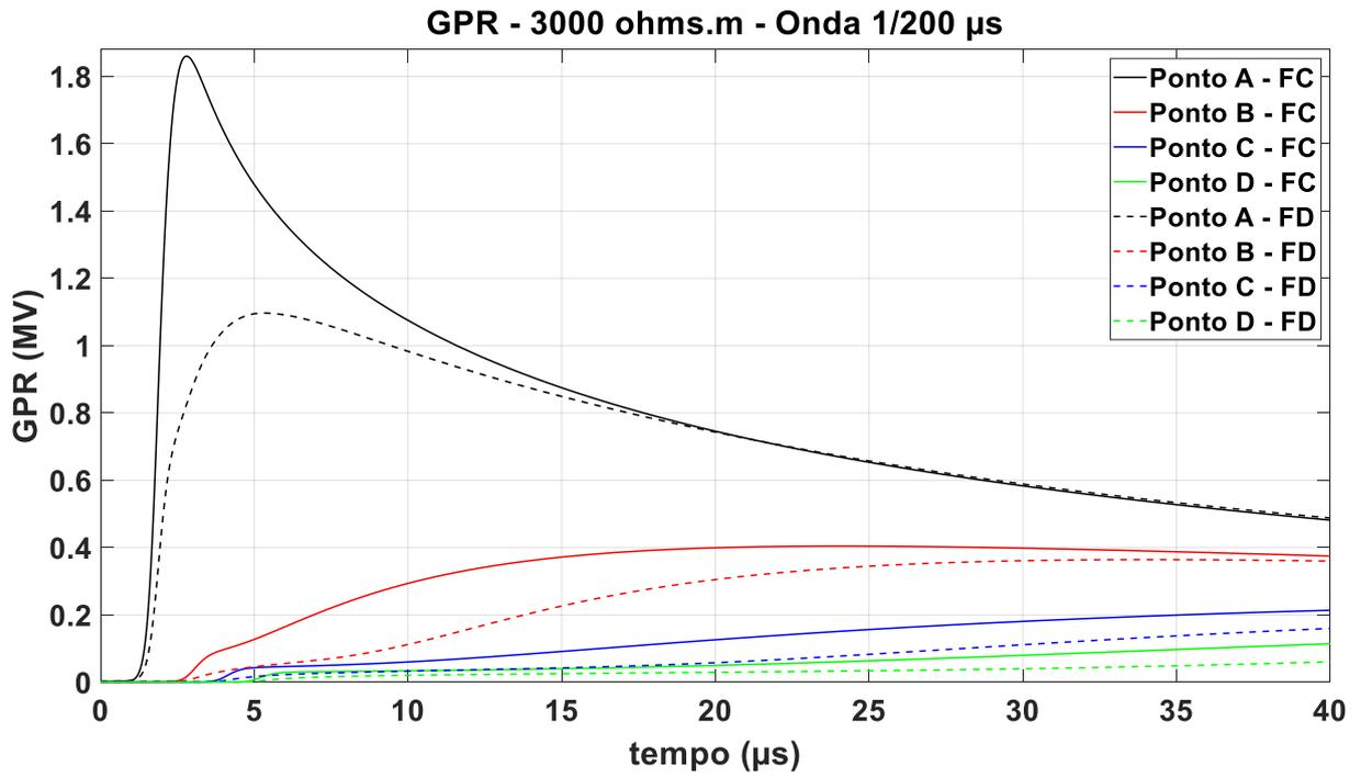
Figura 6.2.2.3 – GPR onda 1/200  $\mu$ s – Solo de 3.000  $\Omega$ .m, fonte: autor
