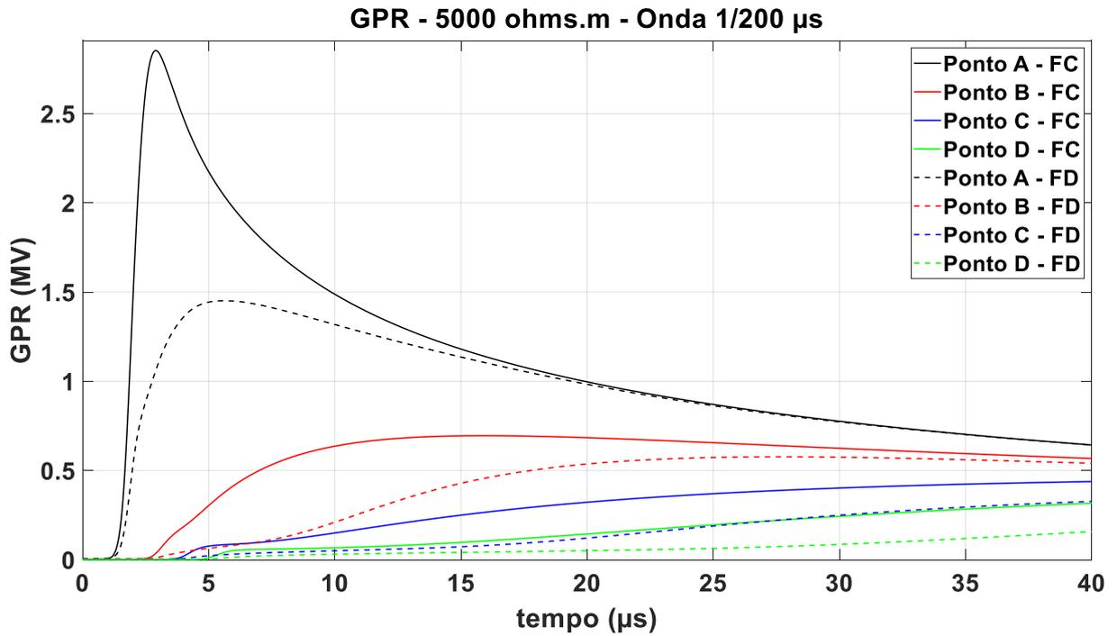
Figura 6.2.2.4 – GPR onda 1/200  $\mu$ s – Solo de 5.000  $\Omega$ .m, fonte: autor
