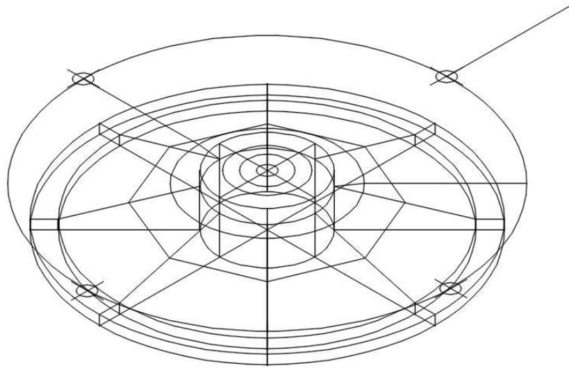
Figura 2.8 – Fundação e anéis de aterramento, típica de um aerogerador em três dimensões com 22 metros de diâmetro, fonte: autor.
