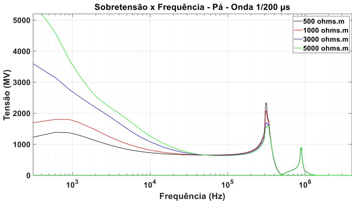
Figura 6.3.2.8 – Espectro de frequência da tensão na pá para onda 1/200  $\mu$ s, fonte: autor
