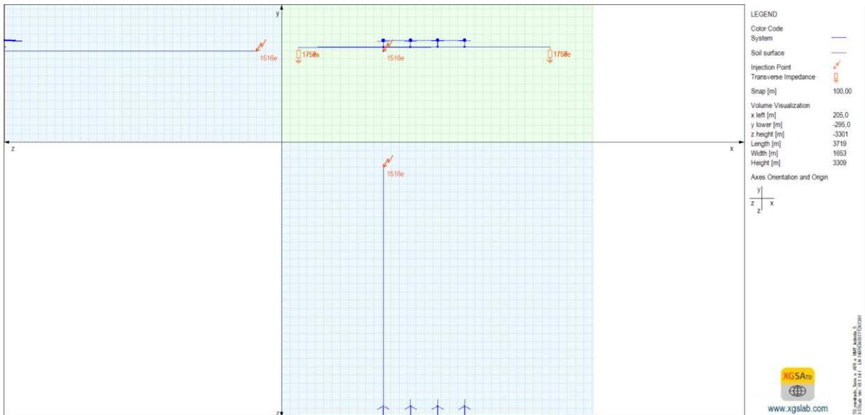
Figura 6.5.2 – Aterramentos interligados com rede de média tensão, descarga próxima a rede de média tensão, detalhe, fonte: autor
