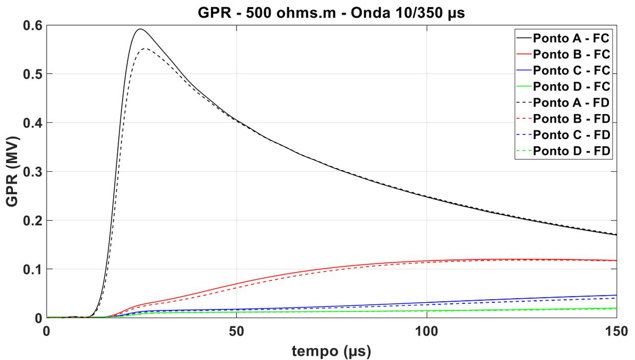
Figura 6.2.1.1 – GPR onda 10/350  $\mu\text{s}$  – Solo de 500  $\Omega\text{.m}$ , fonte: autor
