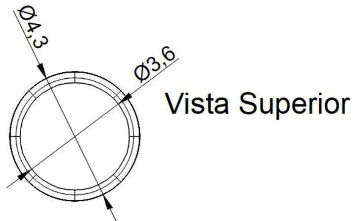
Figura 5.3 – Vista superior da Torre do aerogerador, cotas em metros, Fonte: Autor
