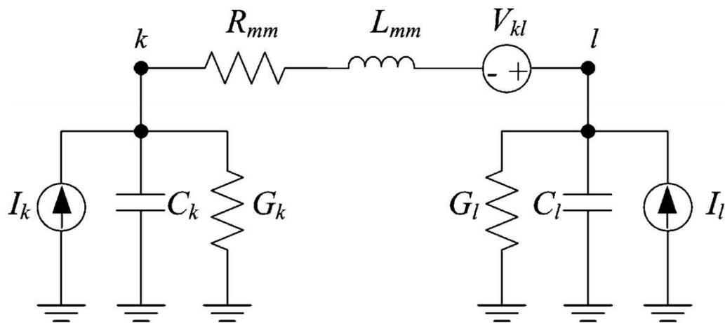
Figura 4.3 – Circuito equivalente do modelo de uma célula do PEEC, (a) Elementos do primeiro grupo. (b) elementos do segundo grupo, Fonte: (Yutthagowith, Ametani, Nagaoka, & Baba, 2011)
