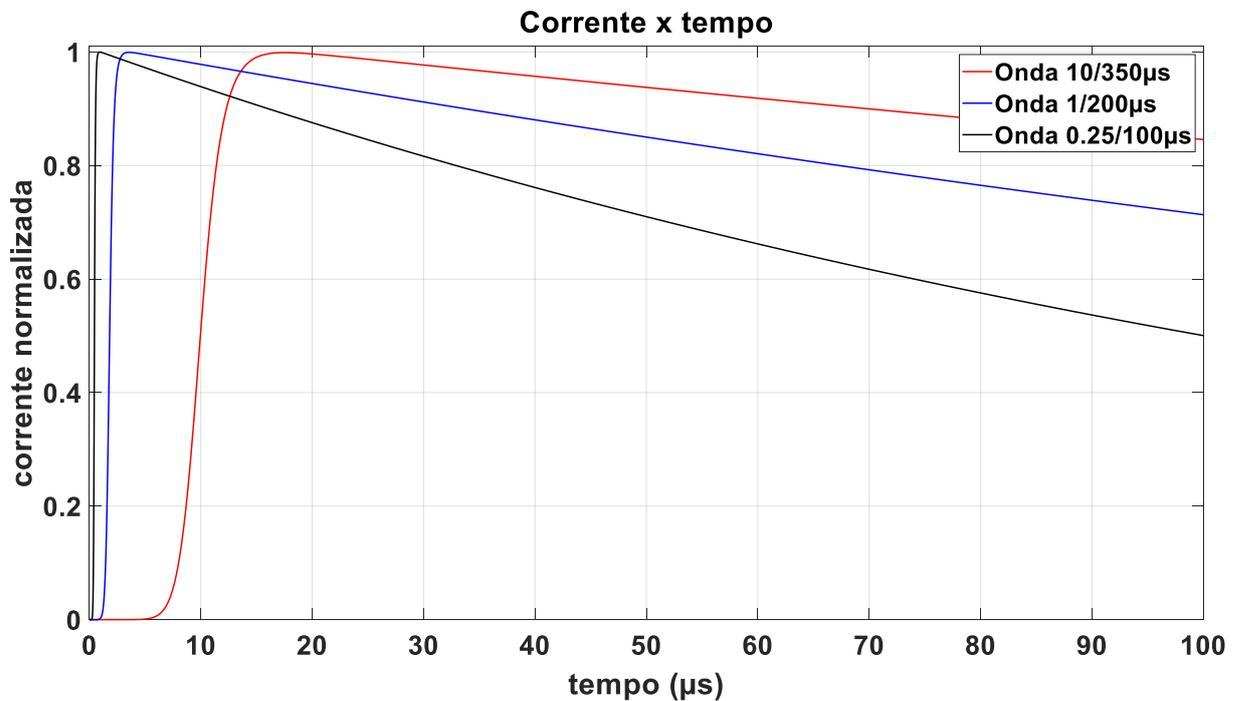
Figura 2.2 – Ondas de Heidler normalizadas 10/350 $\mu\text{s}$ , 1/200  $\mu\text{s}$  e 0,25/100  $\mu\text{s}$ , fonte: Autor.
