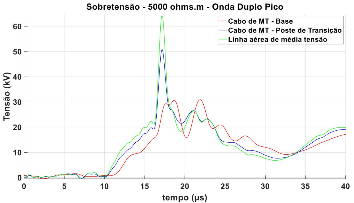
Figura 6.5.4 – Sobretensões onda de duplo pico, solo de 5.000  $\Omega$ .m, fonte: autor
