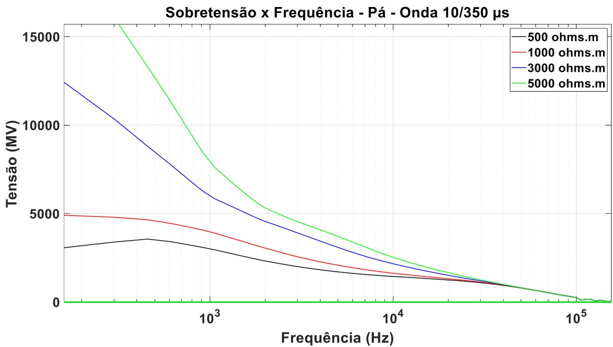
Figura 6.3.1.8 – Espectro de frequência da tensão na pá para onda 10/350  $\mu$ s, fonte: autor
