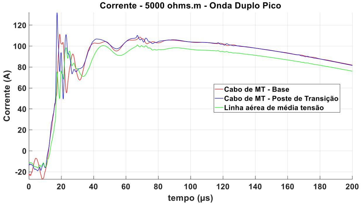
Figura 6.5.3 – Correntes onda de duplo pico, solo de 5.000  $\Omega$ .m, fonte: autor
