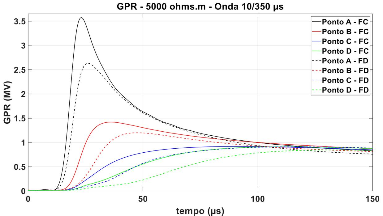
Figura 6.2.1.4 – GPR onda 10/350  $\mu$ s – Solo de 5.000  $\Omega$ .m, fonte: autor
