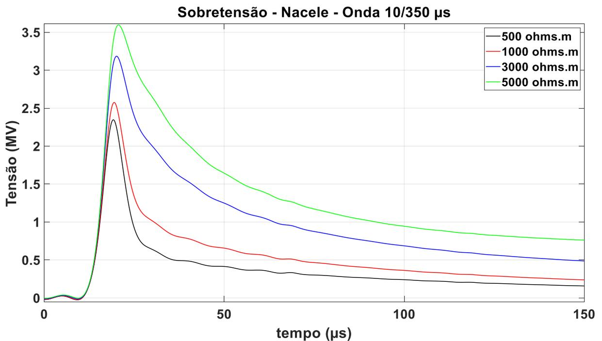
Figura 6.3.1.6 – Sobretensão na nacele, onda 10/350  $\mu\text{s}$ , fonte: autor
