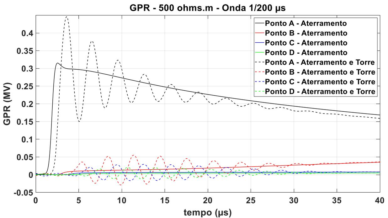
Figura 6.3.2.1 – GPR Onda 1/200  $\mu\text{s}$ , resistividade 500  $\Omega\cdot\text{m}$ , fonte: autor
