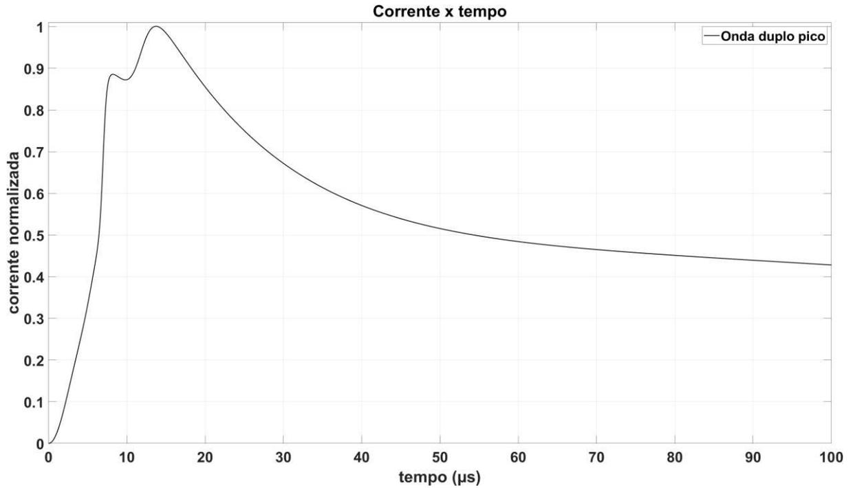
Figura 2.3 - Onda de duplo pico subsequente normalizada, fonte: Autor.
