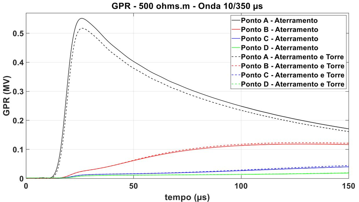
Figura 6.3.1.1 – GPR Onda 10/350  $\mu$ s, resistividade 500  $\Omega$ .m, fonte: autor
