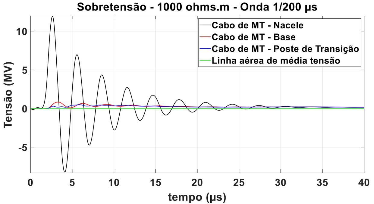
Figura 6.4.2.2 – Sobretensão onda 1/200  $\mu$ s, solo de 1.000  $\Omega$ .m, fonte: autor
