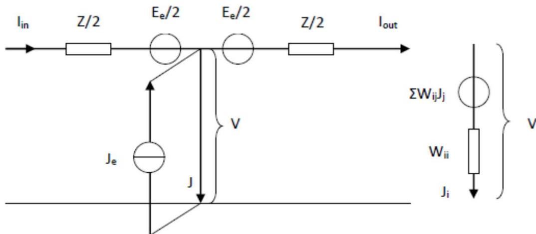
Figura 4.4 – Circuito equivalente de cada elemento modelo “T”, fonte: (Meppelink, Andolfato, & Cuccarollo, 2016)
