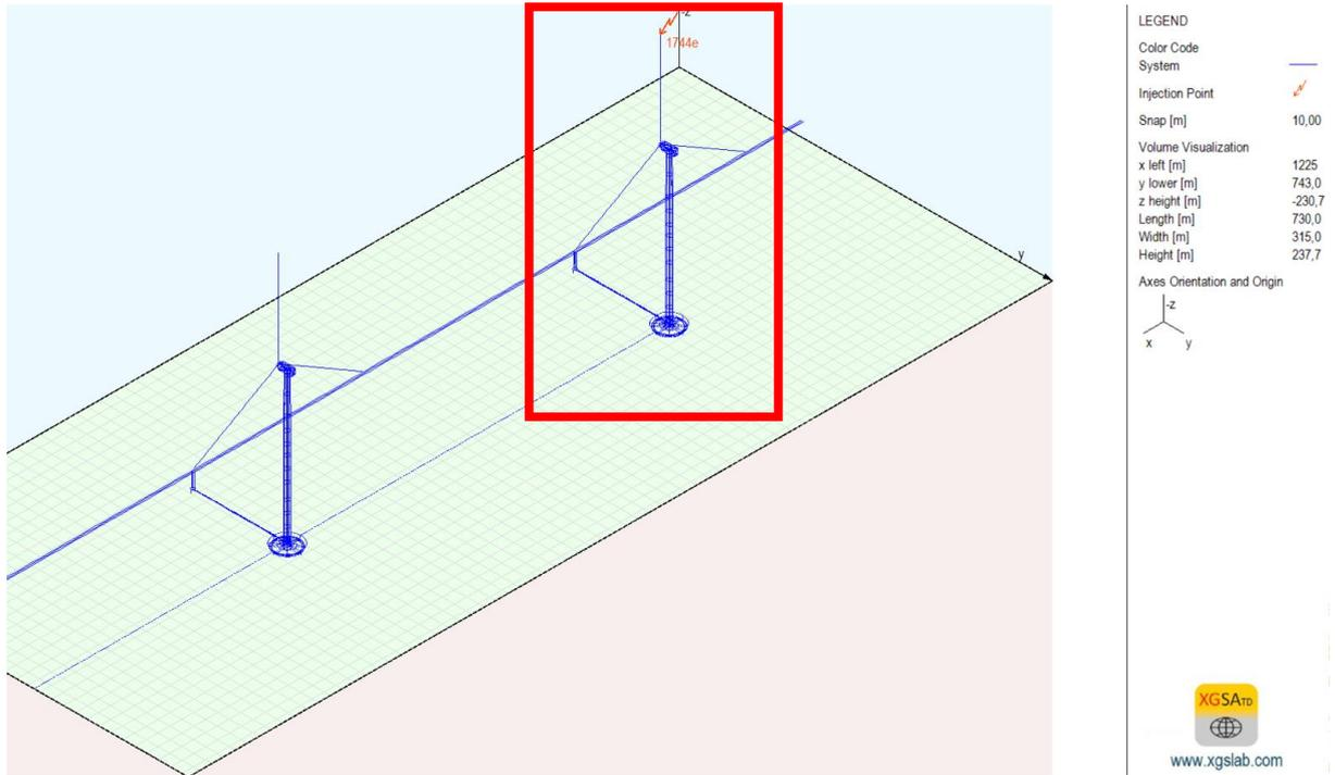
Figura 6.4.2 – Aterramentos interligados com rede de média tensão detalhe em vermelho da área de interesse, fonte: autor
