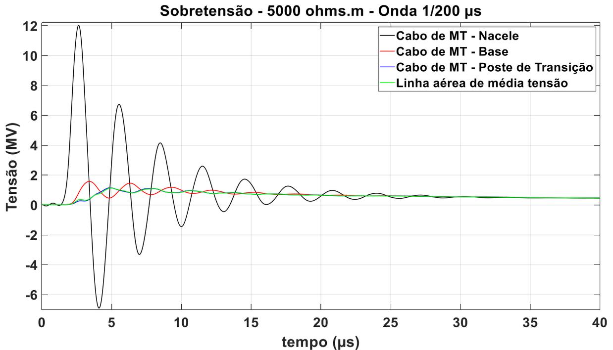
Figura 6.4.2.4 – Sobretensão onda 1/200  $\mu$ s, solo de 5.000  $\Omega$ .m, fonte: autor
