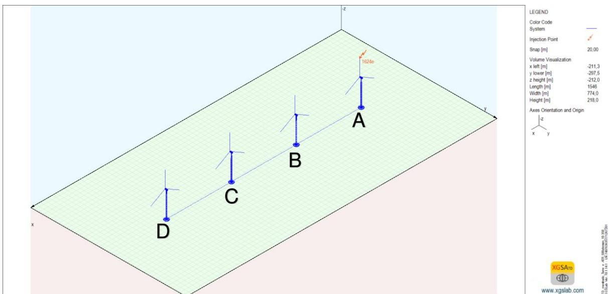
Figura 6.3.1 – Aerogeradores e aterramentos interligados, fonte: autor
