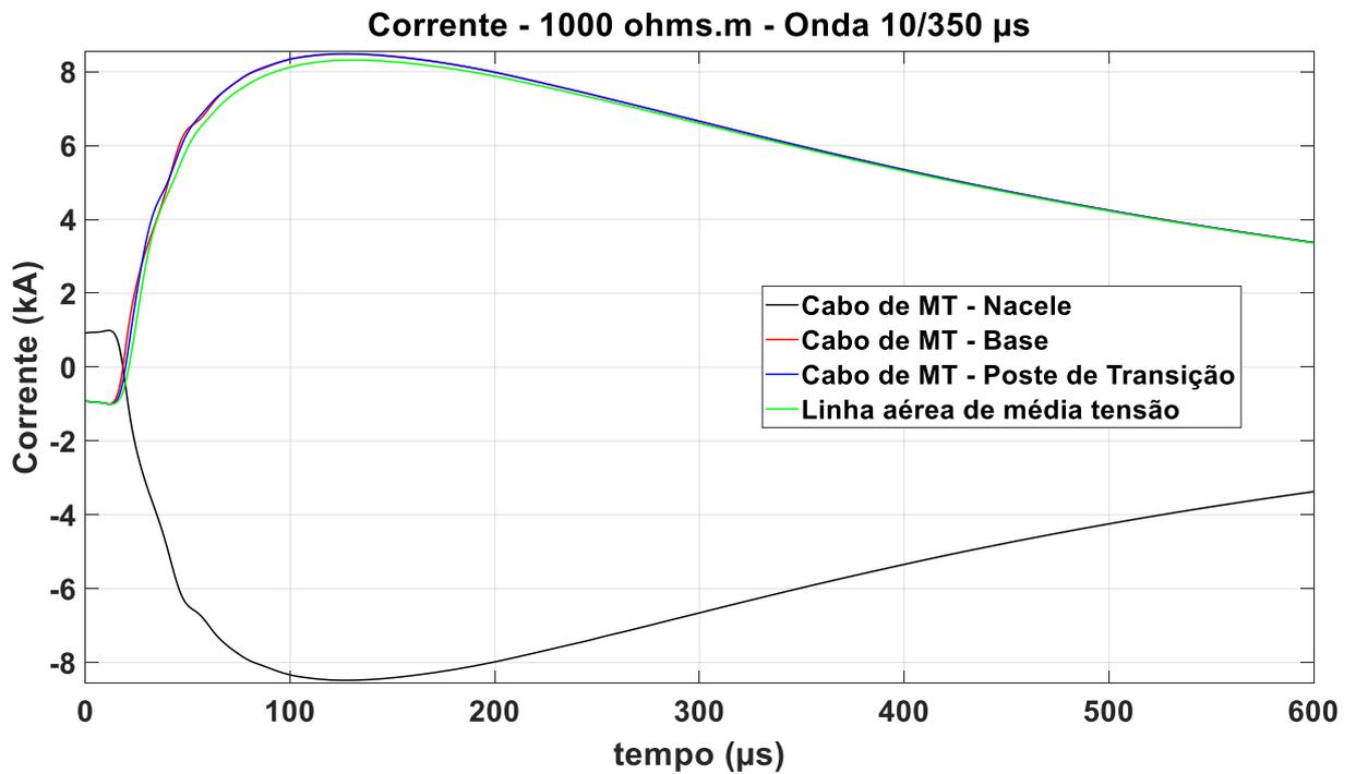
Figura 6.4.1.1 – Correntes onda 10/350  $\mu$ s, solo de 1000  $\Omega$ .m, fonte: autor
