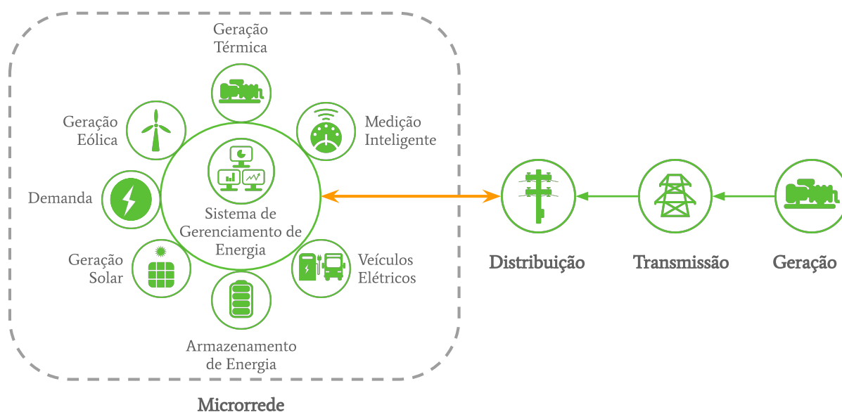
Figura 1.1 – Componentes de uma microrrede ligada ao sistema de distribuição.
