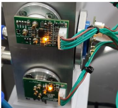
Figura 45 - Placas com circuito eletrônico desenvolvido no projeto para a leitura dos sensores
