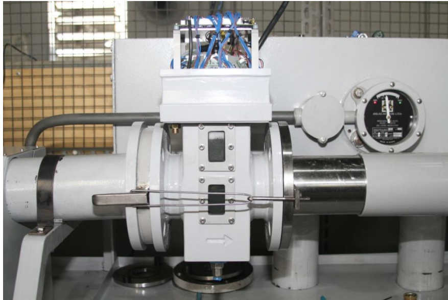
Figura 70 - Visão frontal do RPMA sem proteção da eletrônica
