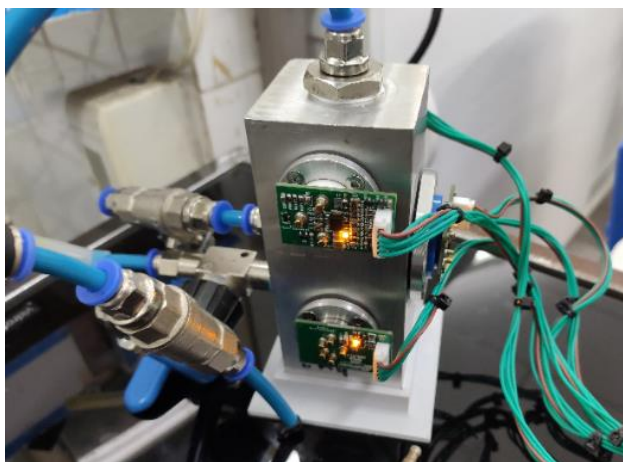
Figura 52 - Câmara para ensaios de temperatura e sensibilidade cruzada
