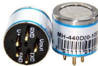
Figura 37 - Sensor de CH 4 (fonte: catálogo Winsen Electronics Technology)
