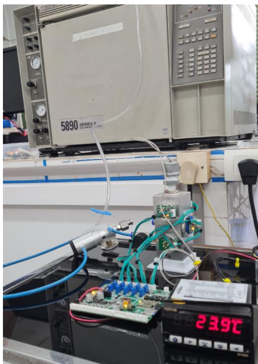
Figura 53 - Montagem do sistema - Cromatógrafo, câmara, placa eletrônica e acessórios
