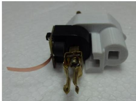
Figura 3.29 – Parte do encapsulamento da EPSCE com o sensor na PCI acoplado ao pino de fase.
