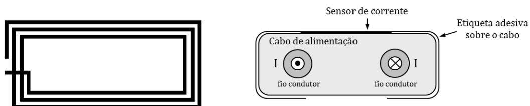
Figura 2.8 – Sensor de corrente. Colocação sobre o cabo – Opção 1.
