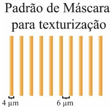
**Fig. 3.4: padrão de linhas paralelas com 4  $\mu\text{m}$  de largura, espaçadas 6  $\mu\text{m}$  entre si, da máscara de cromo de campo claro, utilizada para a texturização das estruturas de V-groove, pirâmides verticais e pirâmides invertidas na superfície do c-Si.**
