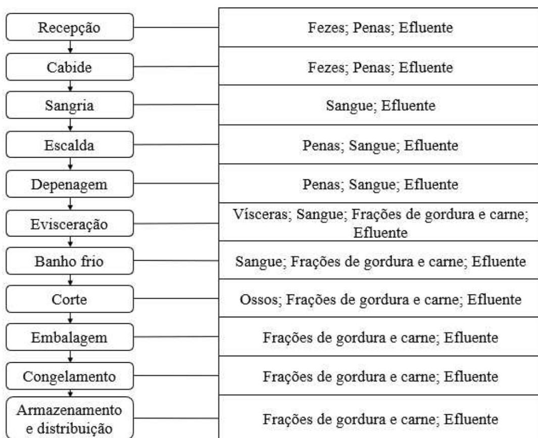
Figura 1. Fluxograma e geração de resíduos do processamento da carne de frango (Fonte: Adaptado de FERREIRA et al., 2018). Autorização de uso disponível no Anexo.
