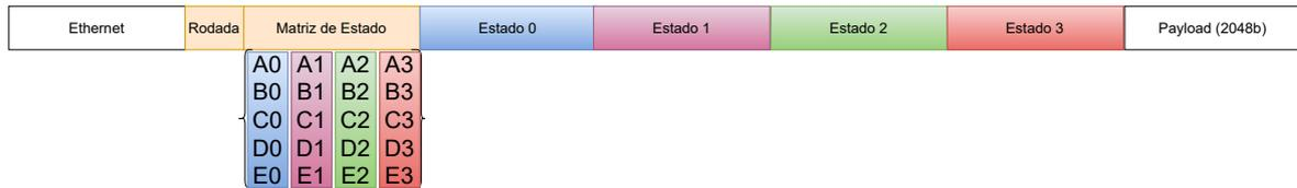
Figura A.11 – Esquema de cabeçalhos para cálculo de quatro estados do Forro14.
