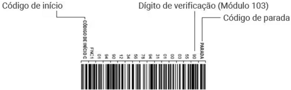
Figura 2.9: Exemplo de um Código de Barras 128. Adaptado de (KEYENCE CORPORATION, s.d.)
