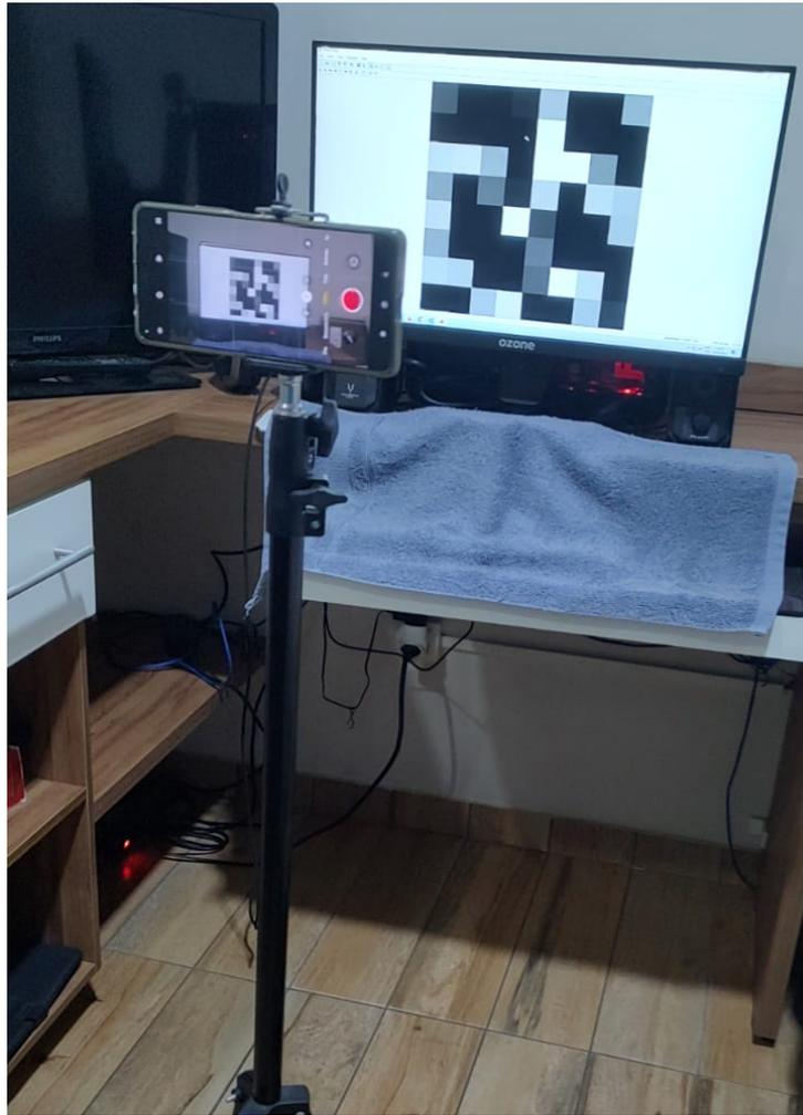
Figura 5.15: Demonstração do ambiente de gravação. O *smartphone* está fixado a um tripé ajustável para poder ser posicionado adequadamente em relação a tela transmissora dos códigos tensoriais.
