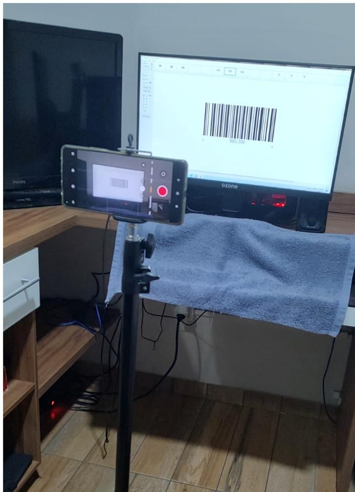
Figura 4.1: Demonstração do ambiente de gravação. O *smartphone* está fixado a um tripé ajustável para poder ser posicionado adequadamente em relação a tela transmissora dos códigos de barras.
