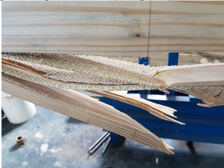
Figura 69 – Deslocamento do reforço da viga reforçada com Sisal SIS2
