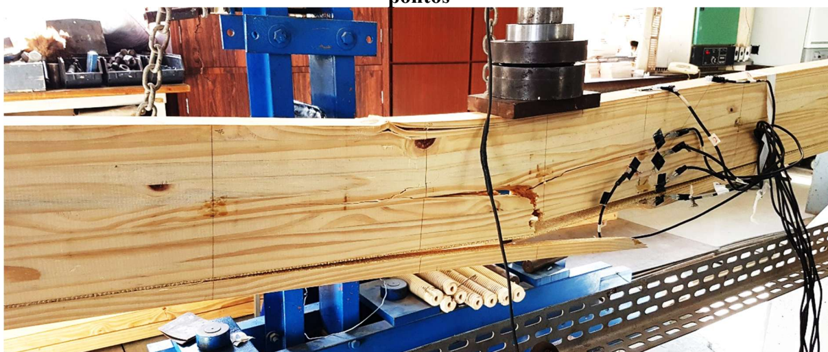
Figura 64 – Viga reforçada com Sisal SIS1 após a ruptura em ensaio de flexão a três pontos
