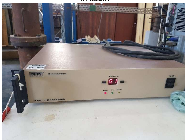
Figura 15 – Aquisitor de dados utilizados para captar os sinais dos sensores e converter os dados
