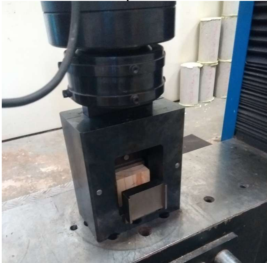
Figura 22 – Ensaio de cisalhamento em corpo de prova por meio do uso do acessório EMIC para ensaio
