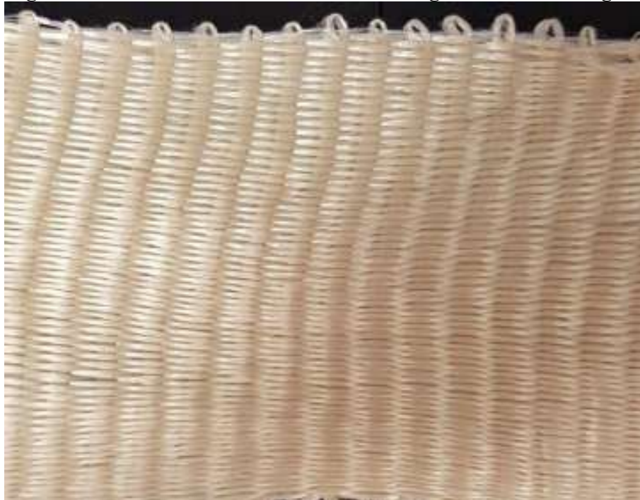
Figura 4 – Malha de fibra Vectran HT com gramatura de 408g/m 2
