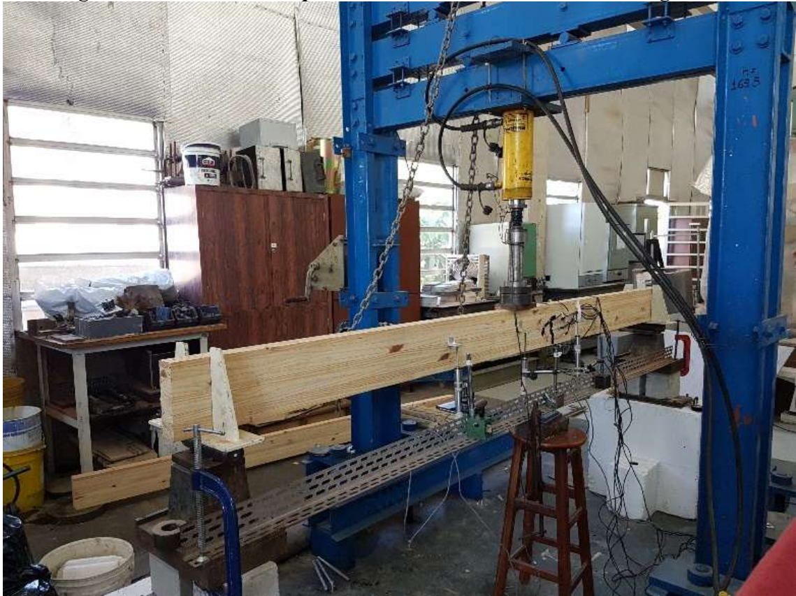
Figura 8 – Ensaio de três pontos realizado no laboratório em viga MLC
