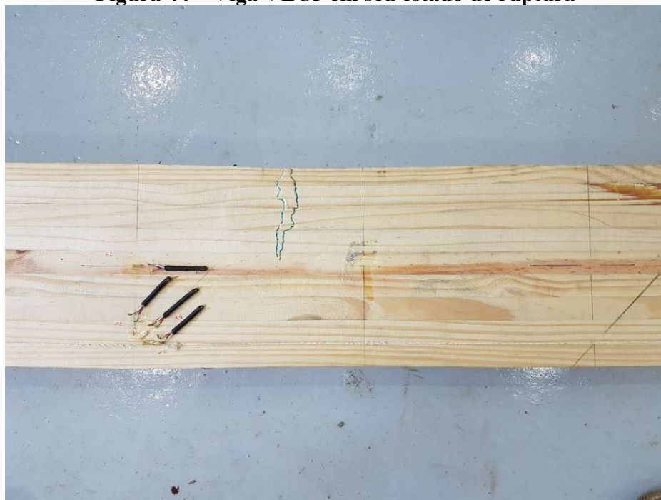
Figura 44 – Viga VEC3 em seu estado de ruptura
