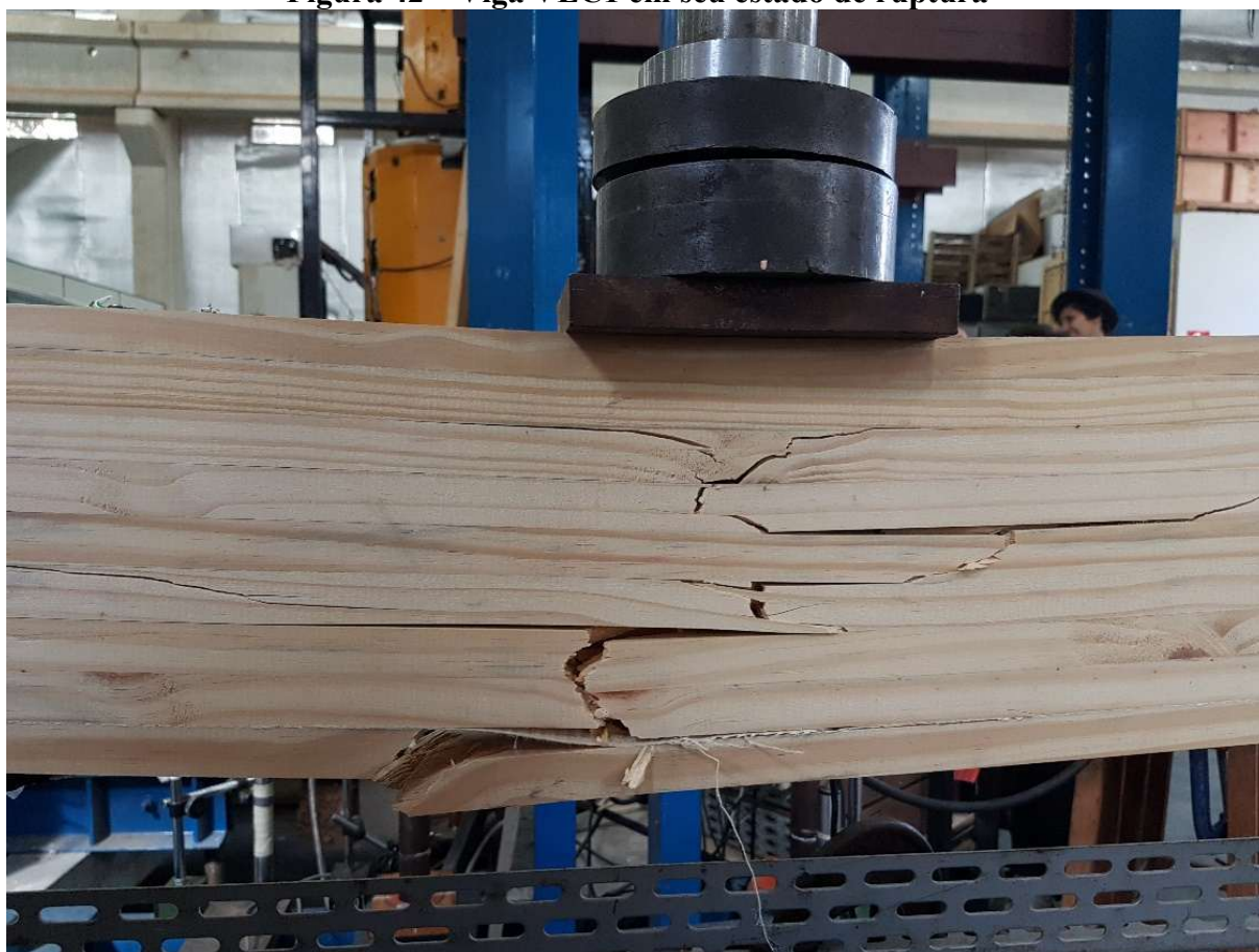
Figura 42 – Viga VEC1 em seu estado de ruptura
