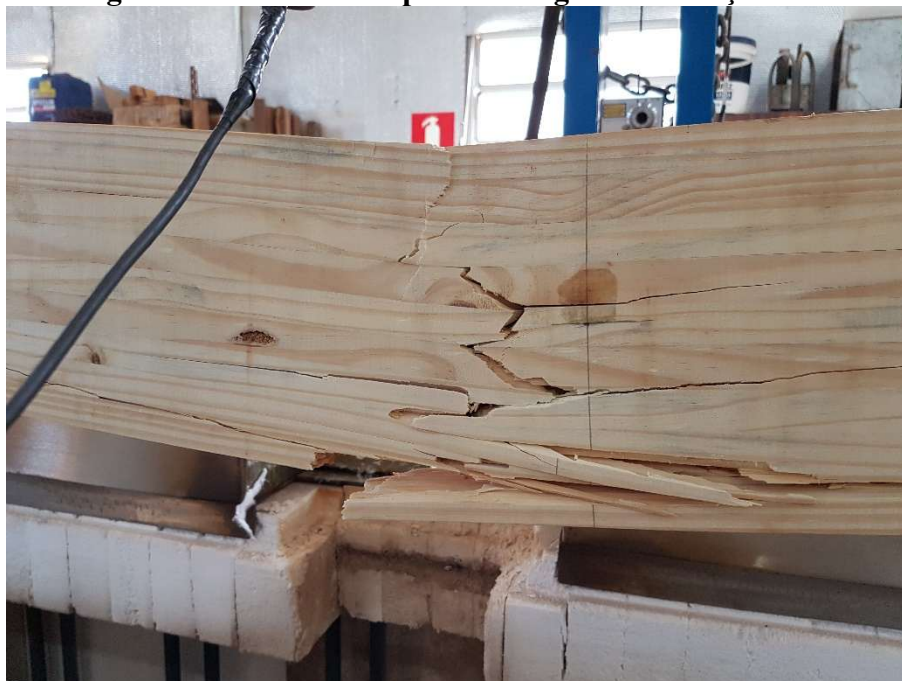
Figura 37 – Modo de ruptura da viga sem reforço VSR3
