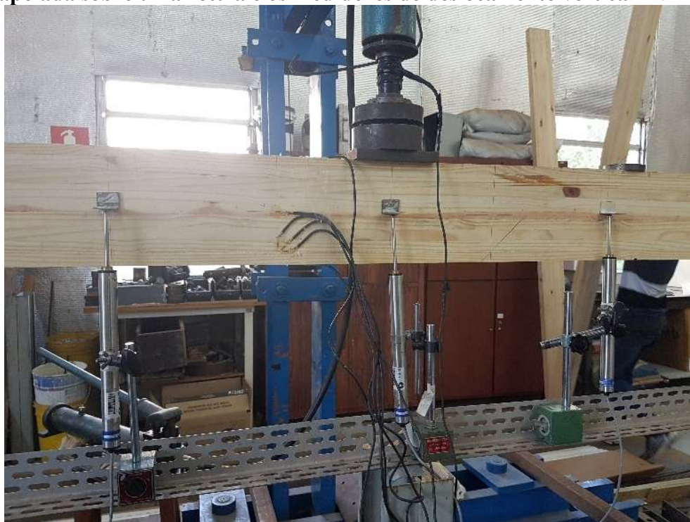
Figura 13 – Detalhe da viga posicionada para ensaio mostrando a célula de força apoiada sobre uma rótula e os medidores de deslocamento vertical LVDT
