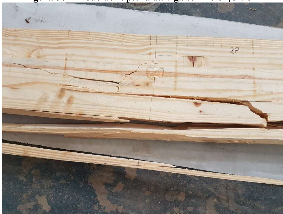
Figura 36 – Modo de ruptura da viga sem reforço VSR2
