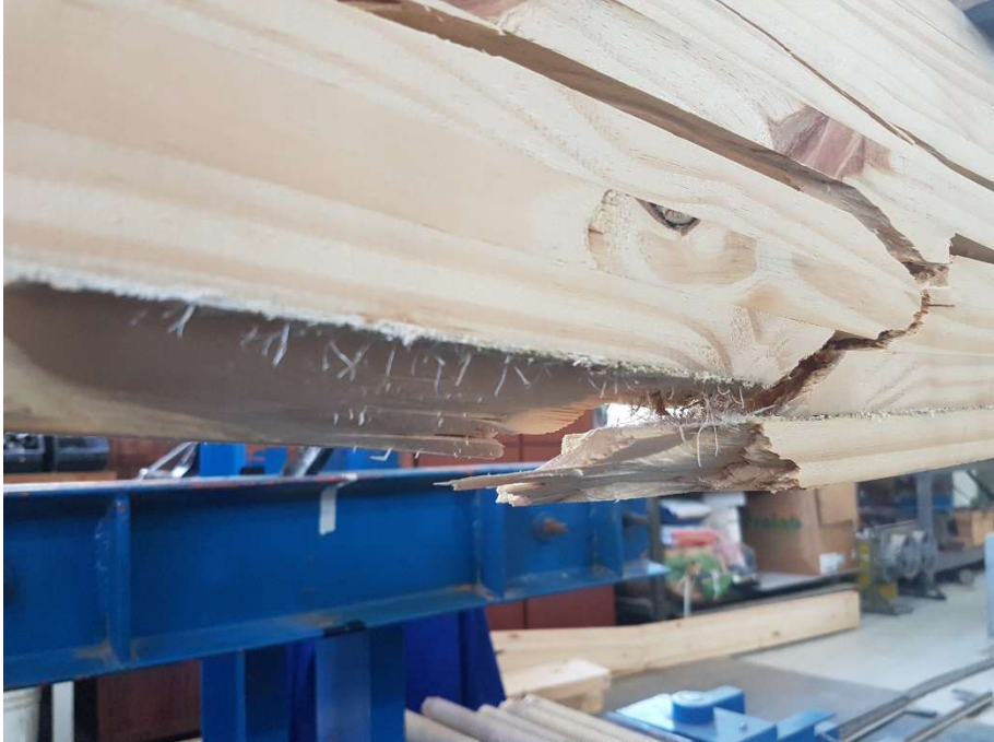
Figura 57 – Região do reforço da viga reforçada CUR1 após ruptura
