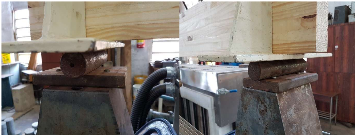
Figura 11 – Detalhe dos apoios móvel e fixo, respectivamente, utilizados nos ensaios de flexão das vigas
