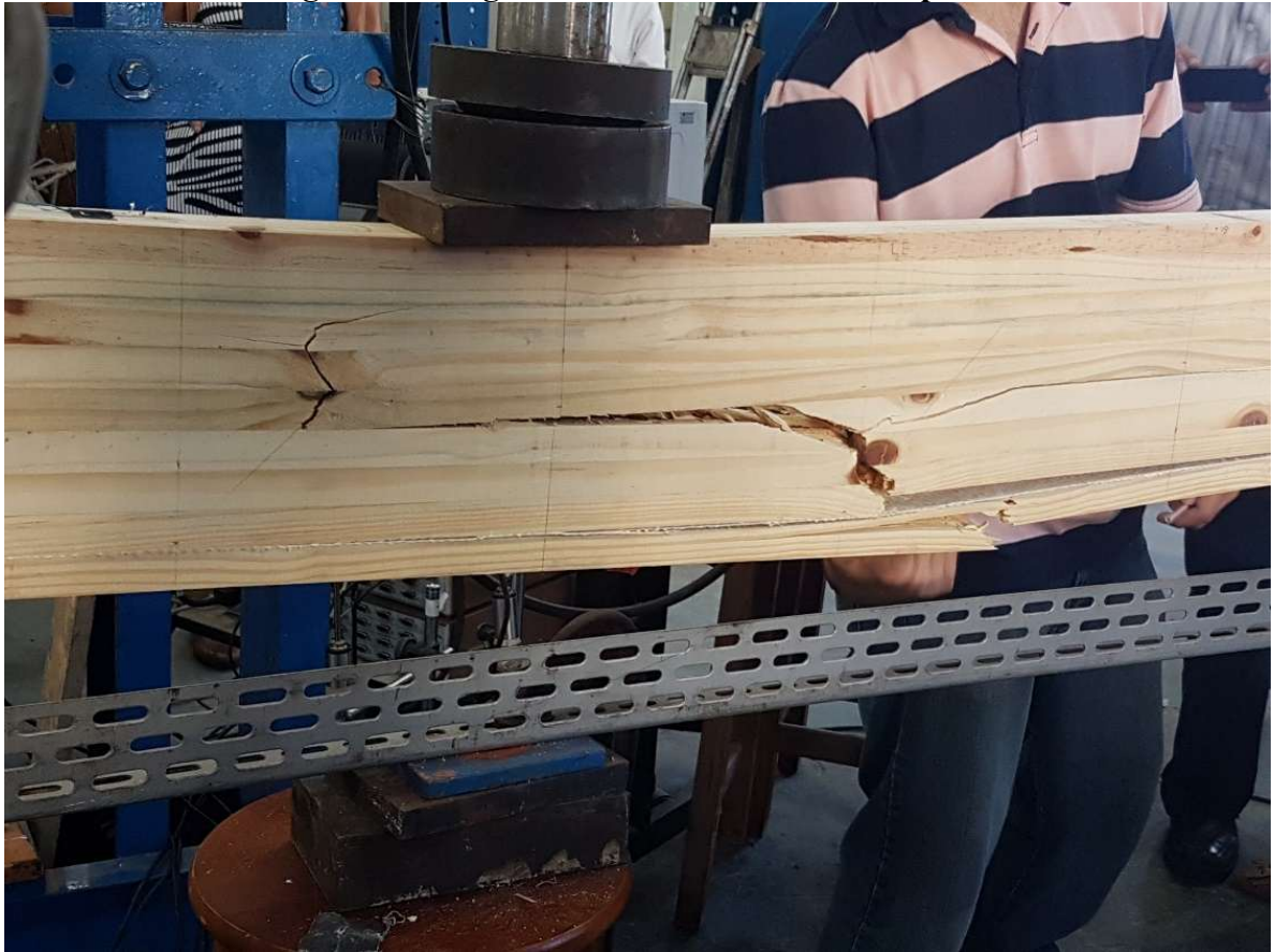
Figura 43 – Viga VEC 2 em seu estado de ruptura
