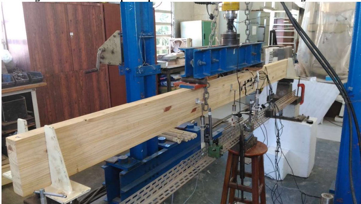
Figura 10 – Ensaio de quatro pontos realizado no laboratório em vigas MLC
