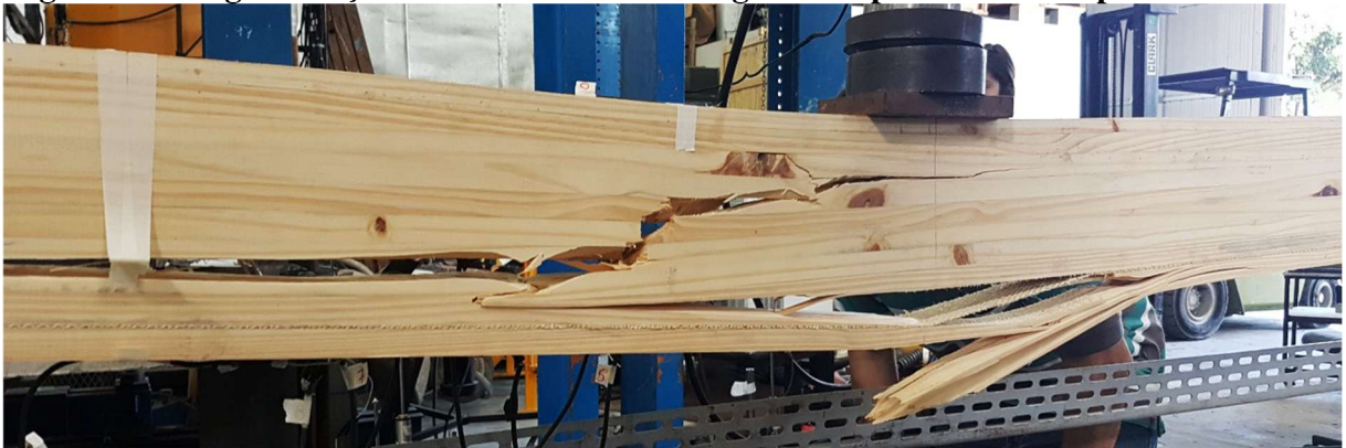
Figura 68 – Viga reforçada com Sisal SIS2 na segunda ruptura com colapso do elemento
