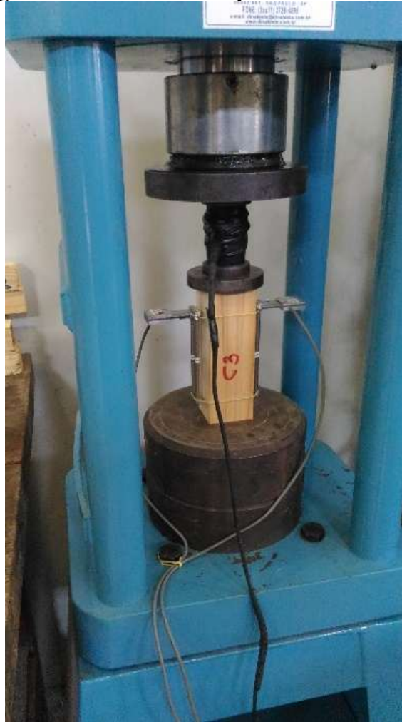
Figura 18 – Ensaio de compressão em execução
