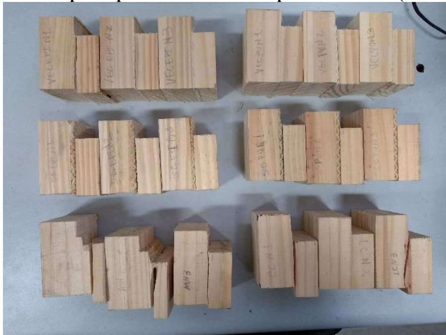
Figura 21 – Corpos de prova de Cisalhamento padrão NBR7190 (ABNT, 1997)
