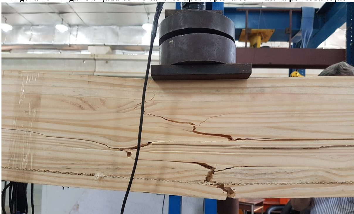
Figura 70 – Viga reforçada com Sisal SIS3 após ruptura com fratura por toda seção
