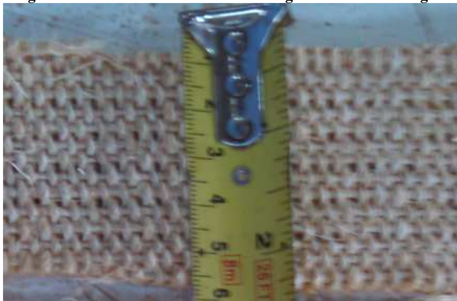
Figura 5 – Malha de fibra de Sisal com gramatura de 1393 g/m 2
