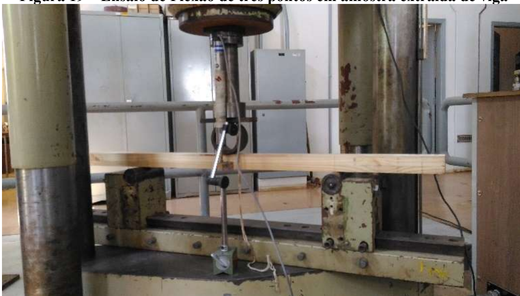
Figura 19 – Ensaio de Flexão de três pontos em amostra extraída de viga
