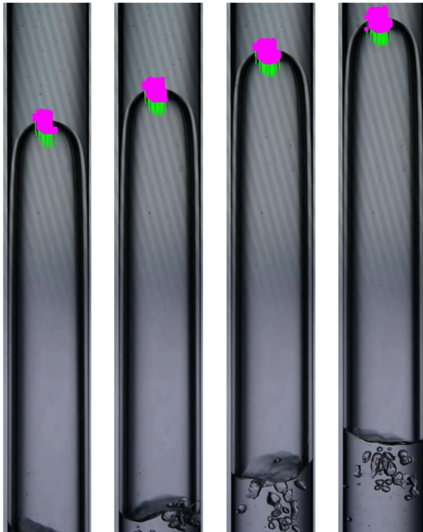
Figura 10: Vetores de deslocamento por pixel formados através do método de fluxo óptico Lucas-Kanade, na ponta da bolha de Taylor.
