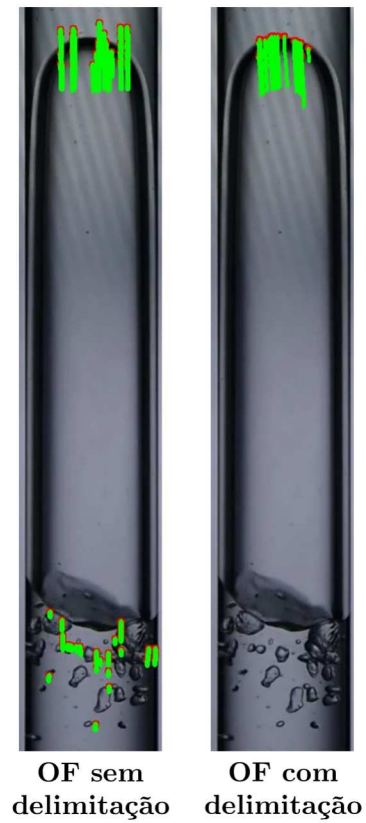
Figura 23: Delimitação da região para aplicação do método de fluxo óptico restrito à ponta da bolha.
