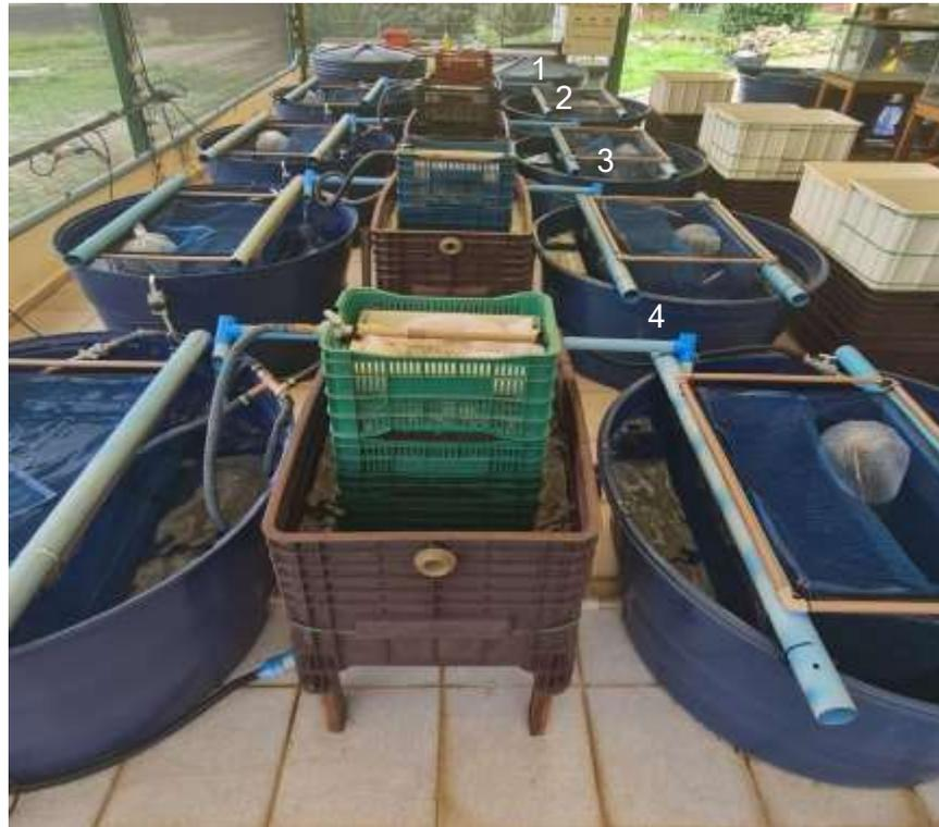
**Figura 10.** Estrutura experimental, composta por quatro linhas, com dois tanques de polietileno de 1.000 litros, dois tanques-rede e um biofiltro. **Fonte:** Autoria própria: Dias, (2024).
