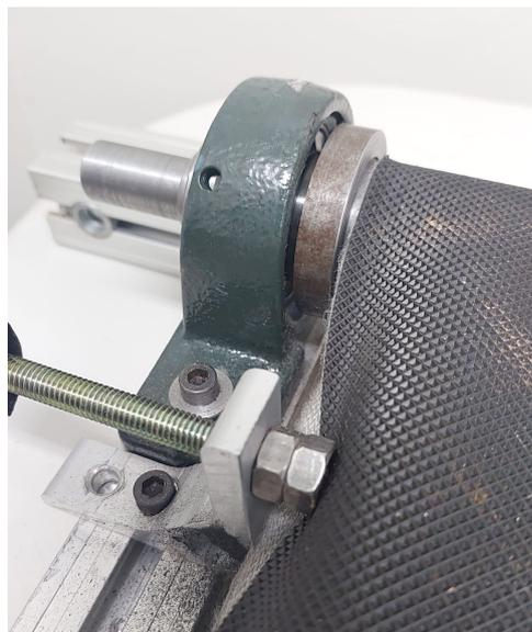
Figura 3.5 – Solução aplicada na planta: anel no eixo e aparato a fim de aplicar uma força perpendicular, impedindo a movimentação da lona.
