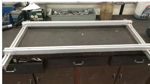
Figura 3.2 – Estrutura montada - apenas com perfil Bosch.
