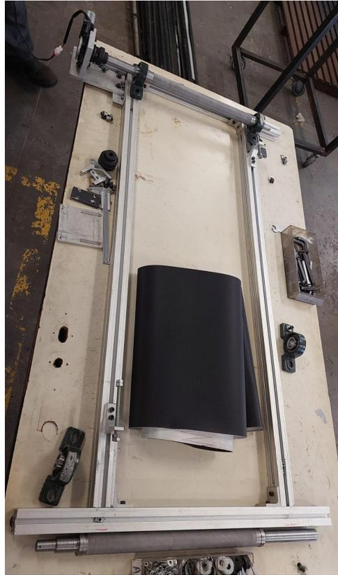
Figura 3.4 – Estrutura montada - com adição dos eixos, mancais e estrutura para motor e encoder.
