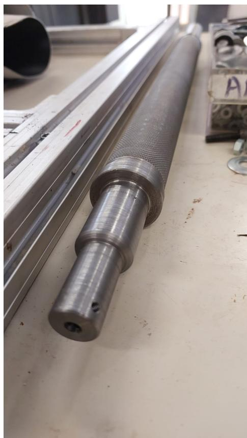
Figura 3.3 – Eixo principal da esteira manufaturado com encaixe para acoplamento do encoder, do lado visível, e do motor no lado oposto.
