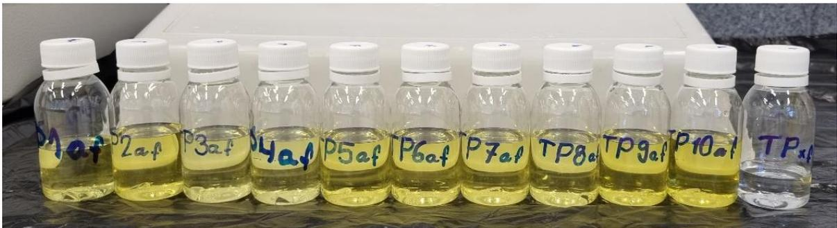
Figura 14 – Soluções-teste e branco da extração de fósforo total (TP).
