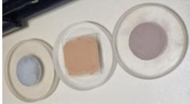
Figura 20 – Porta amostras utilizados no laboratório de difração de raios X.
