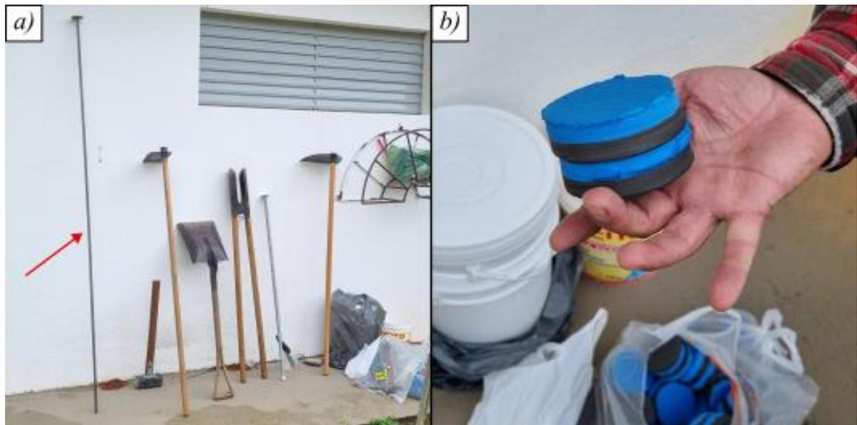
Figura 8 – Ferramentas utilizadas em campo. *a)* Ferramentas de manejo do sedimento, com destaque na seta em vermelho para o instrumento removedor de sedimento. *b)* Discos de EVA.
