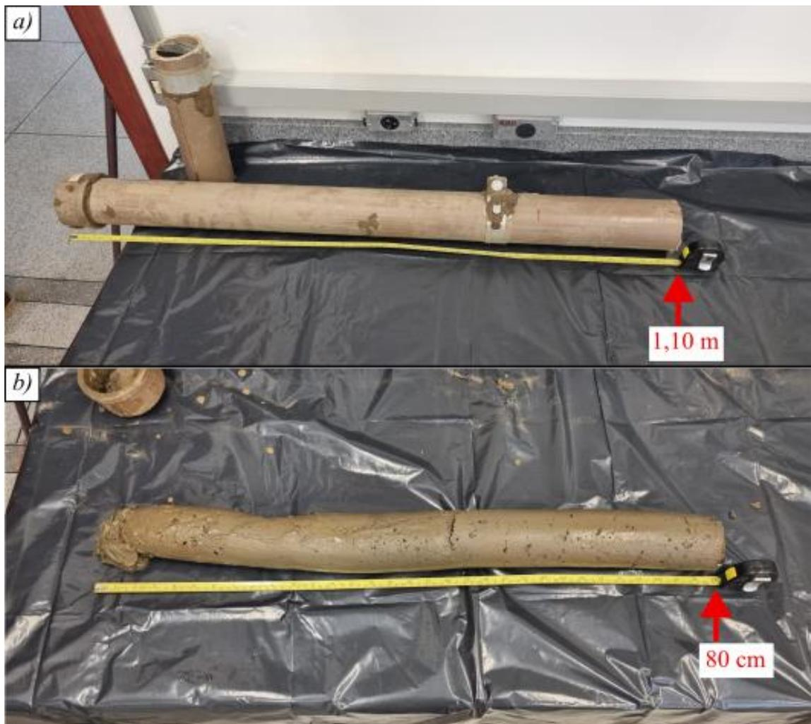
Figura 11 – Tubo testemunho de sedimento do rio Atibaia. *a)* Tubo seccionado para remoção do sedimento. *b)* Testemunho de sedimento assim que foi removido.
