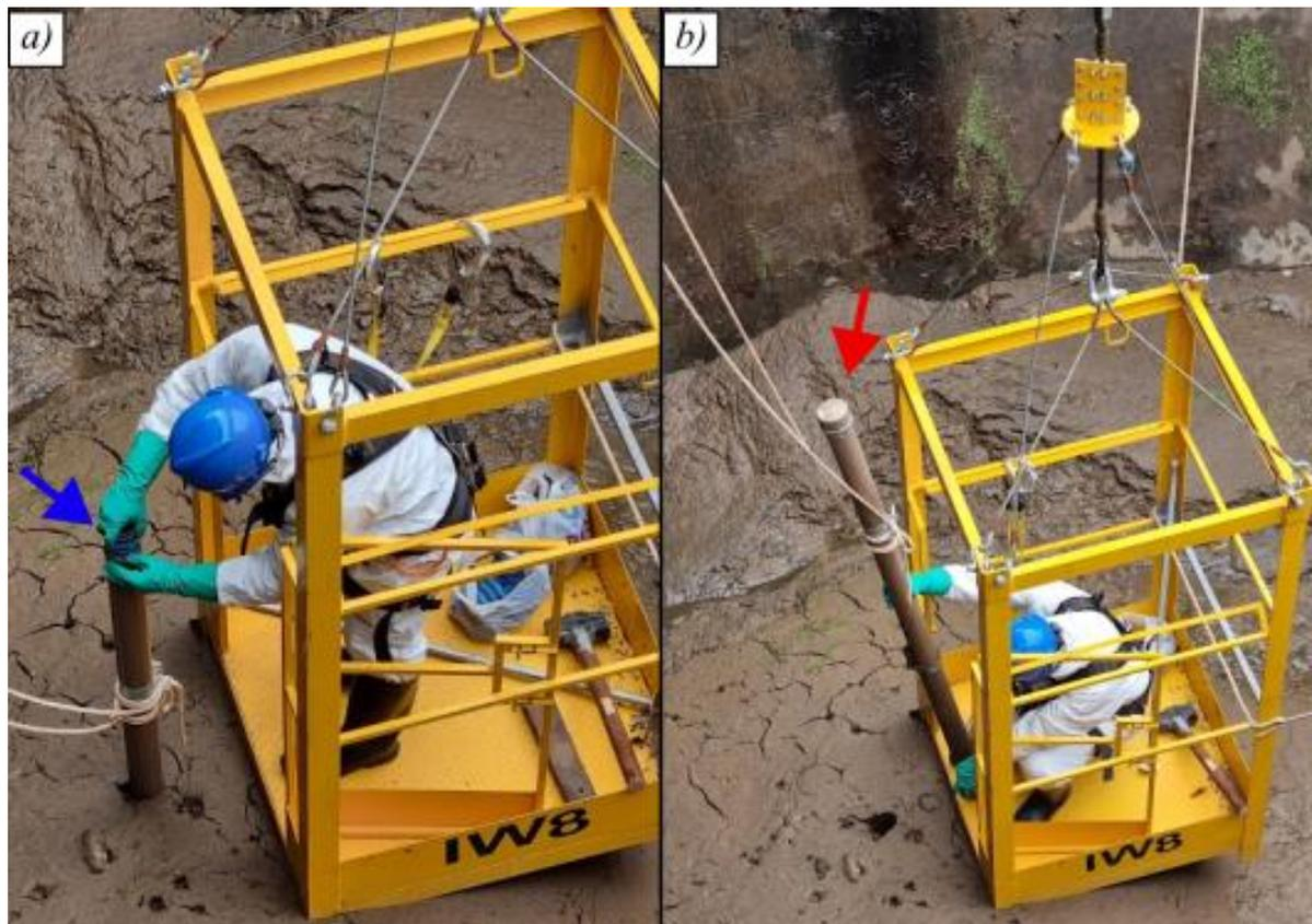
Figura 10 – Procedimentos de remoção do tubo testemunho. *a)* Destaque da seta em azul para a inserção de discos de EVA. *b)* Instalação do tampão inferior, com destaque para o tampão superior já encaixado.
