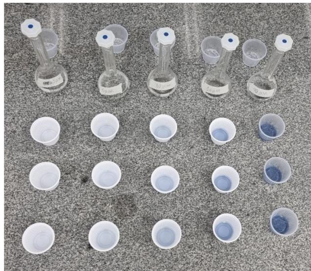
Figura 17 – Esquema de preparação das leituras para a curva de calibração. Balões volumétricos com soluções-padrão de 2, 5, 10, 20 e 40  $\mu\text{M}$ , da esquerda para a direita. Três copinhos plásticos utilizados para cada padrão.
