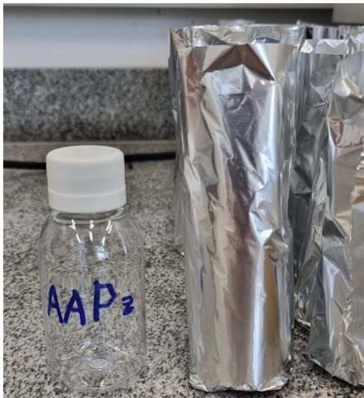
Figura 15 – Modelo de envoltório de papel alumínio para os frascos de extrações.
