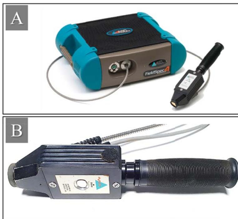
**Figura 4.6 - (A) Espectrorradiômetro FieldSpec® 4 Standard-Res da ASD (Analytical Spectral Devices Inc.), com 2151 canais, utilizado para fazer medidas pontuais nos afloramentos e nas amostras de mão coletadas; (B) Sonda de contato modelo ASD, com campo circular de 1 cm utilizada em laboratório.**
