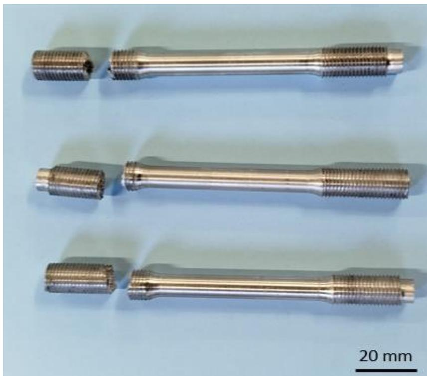
Figura 5.32 - Corpos de prova injetados convencionalmente que romperam na região da rosca.
