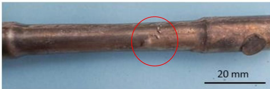
Fig. 5.19 - Detalhe mostrando bolhas superficiais para a condição injetada após tratamento térmico T6, não observadas nos semissólidos.
