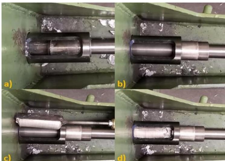
Figura 5.1 - a) configuração da câmara de injeção utilizada nos ensaios de injeção convencional e reofundição b), c) e d) configuração utilizada nos ensaios de tixoconformação.
