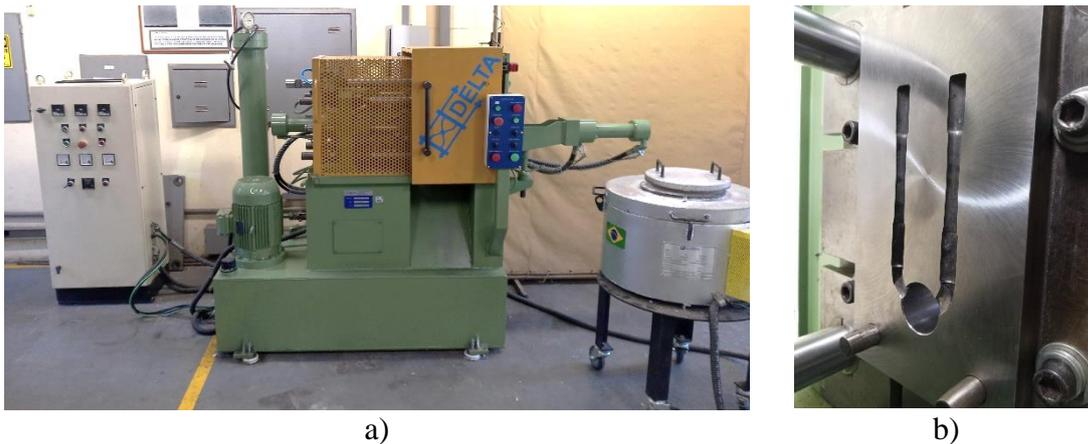
Figura 4.2 - a) Célula de injeção do laboratório de processos de fabricação do Departamento de Engenharia e Manufatura e Materiais (DEMM) b) Lado fixo da matriz da injetora.
