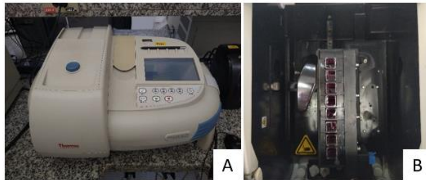
Figura 4 – (A) Espectrofotômetro UV-Visible. (B) Cubetas do equipamento preenchidas com amostras.
