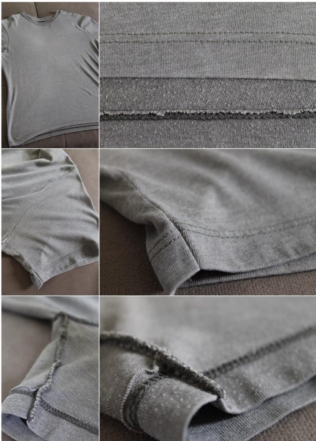
FIGURA 16 – Costura por máquina overloque e galoneira em uma camiseta básica
