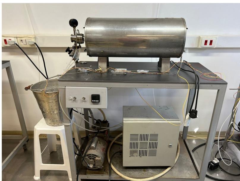
Figura 25 – Forno tubular com aquecimento resistivo com controle eletrônico de temperaturas.
