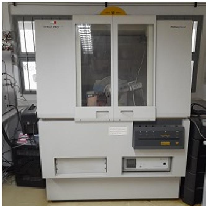
Figura 20 – Equipamento de difração de raios-X Panalytical, modelo X-Pert Pro.
