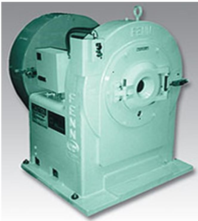
Figura 13 – Forja rotativa FENN, modelo 2H.
