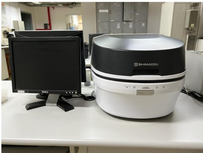
Figura 16 – Equipamento análise fluorescência Shimadzu EDX7000
