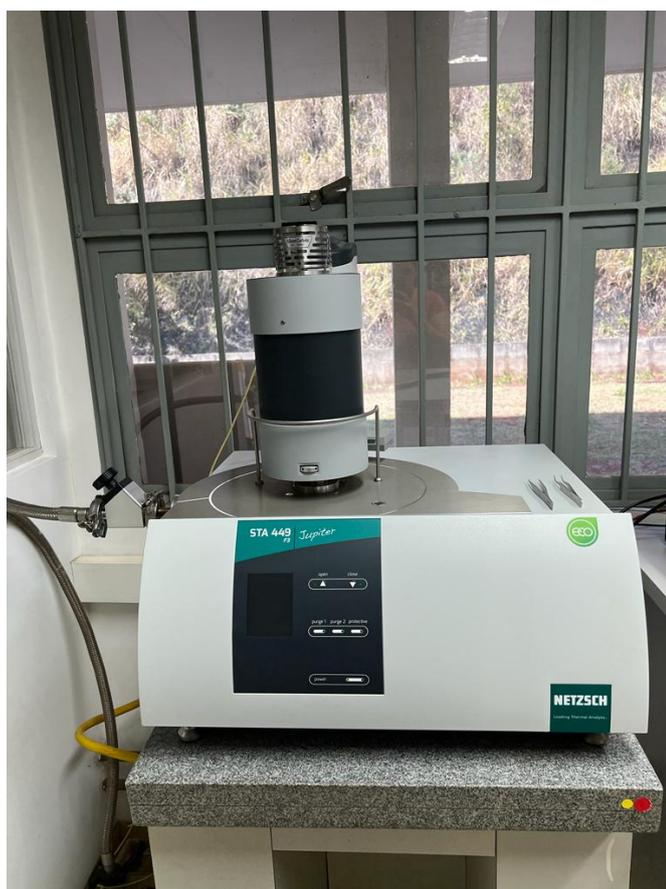
Figura 23 – Equipamento NETZSCH STA 449
