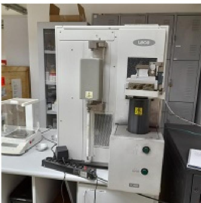
Figura 17 – Analisador de O e N Leco modelo TC400.
