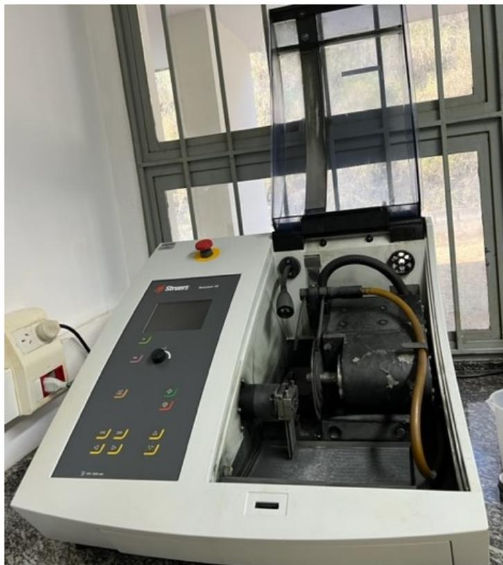
Figura 15 – Máquina de Corte Struers Accutom - 10
