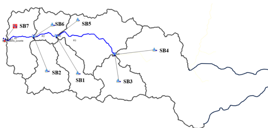
Figura 21 –Representação das sub-bacias da região superior da bacia hidrográfica do Rio Jundiáí
