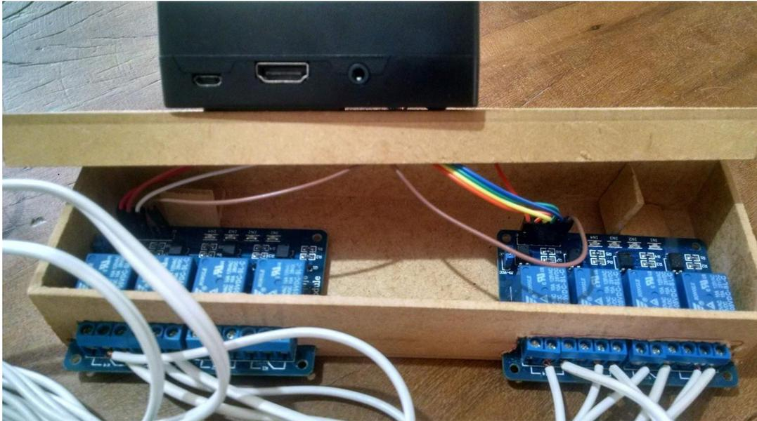
Figura 4 - Módulo controle de luz
