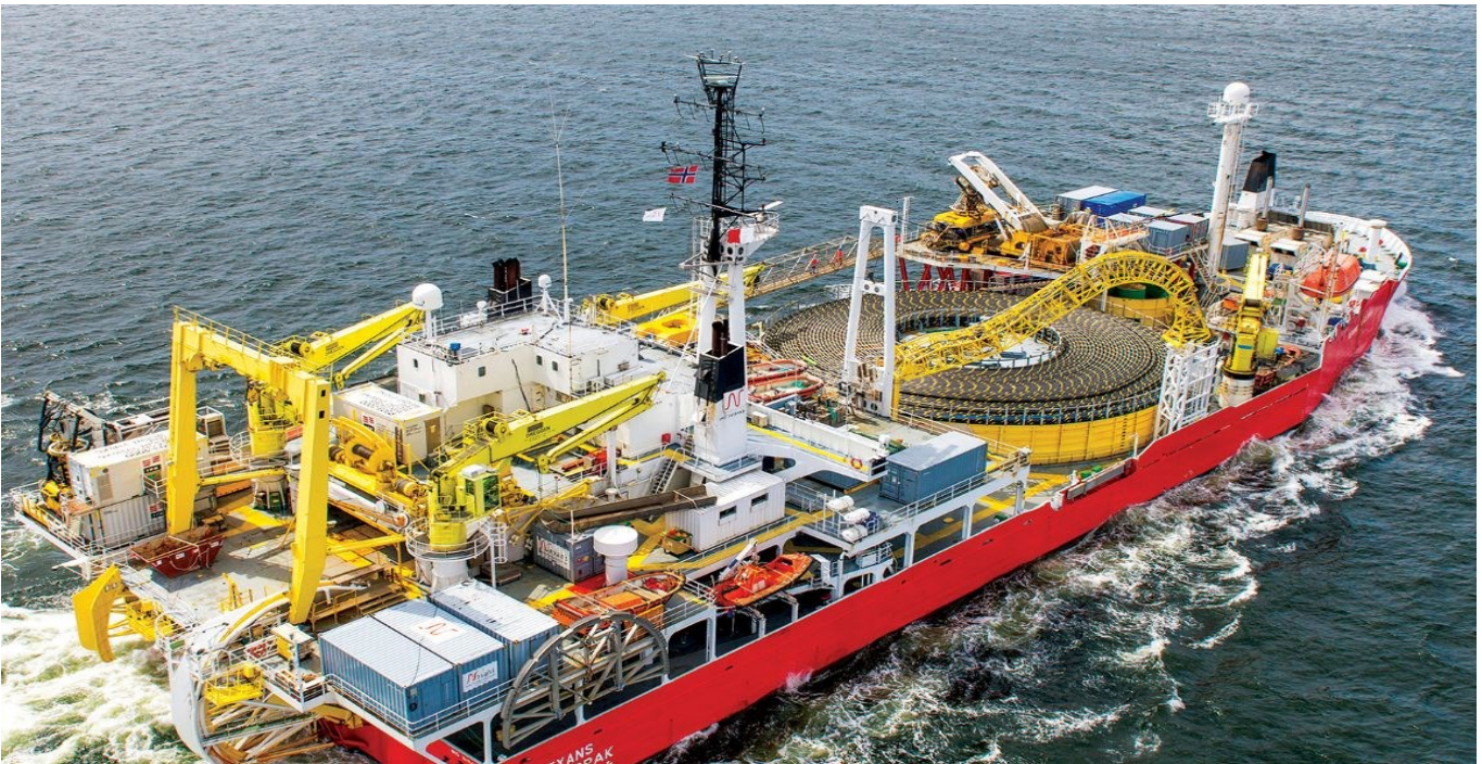
Figura 9 Navio para Instalação de Cabos Submarinos.
