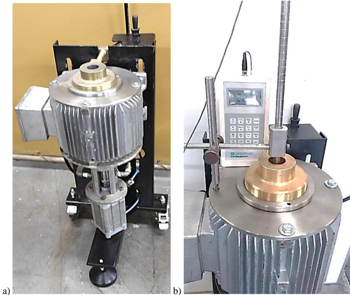
Figura 3.2 – Fotos da lingoteira metálica refrigerada com extrator mecânico pneumático utilizado na produção dos lingotes em a) e em b) detalhe mostrando a utilização do gaussímetro na realização das medições do campo magnético.
