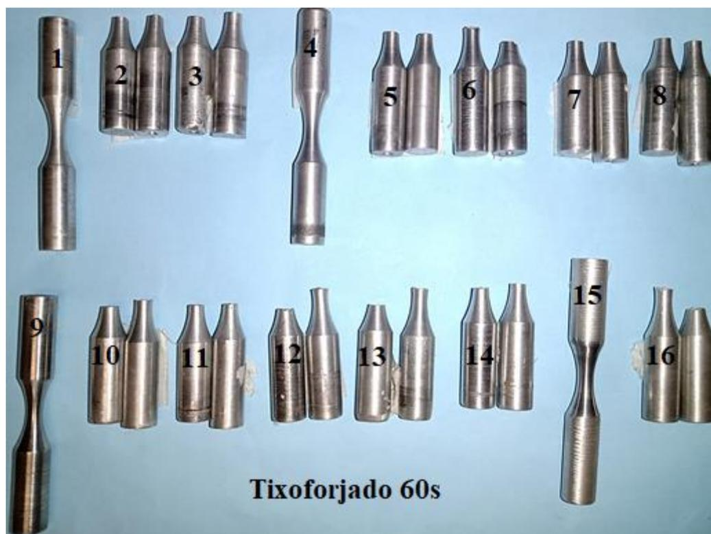
Figura A4 - Corpos de prova ensaiados na condição tixoforjados a 60s.
