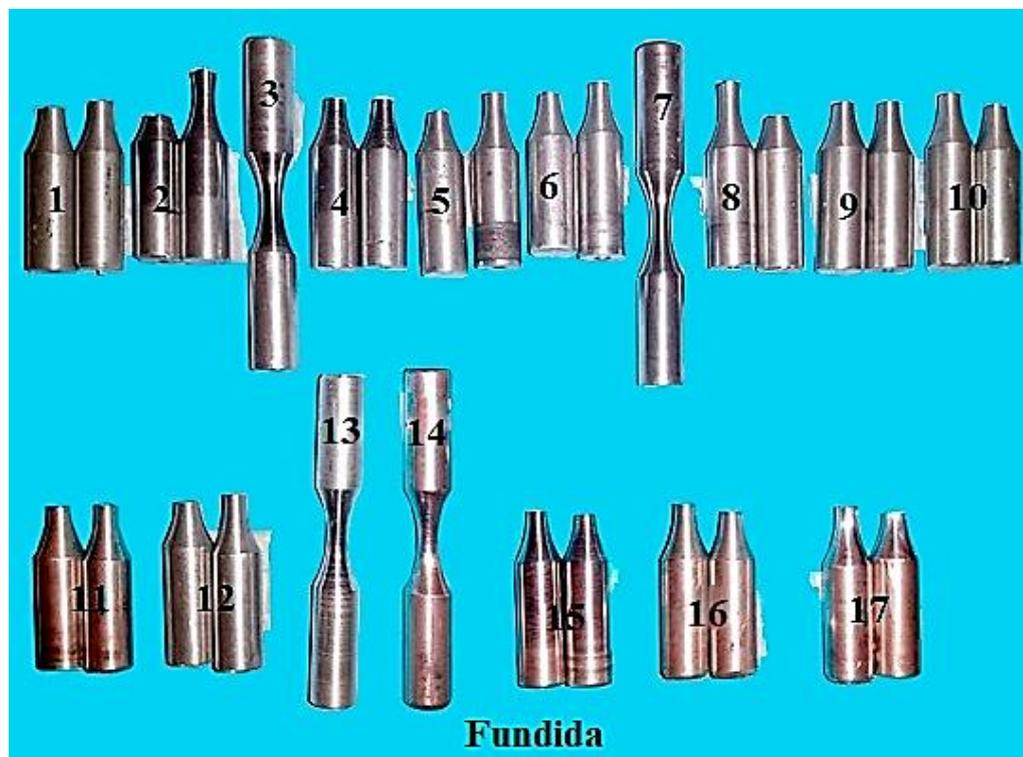
Figura A1 - Corpos de prova ensaiados na condição *as cast* (lingote).
