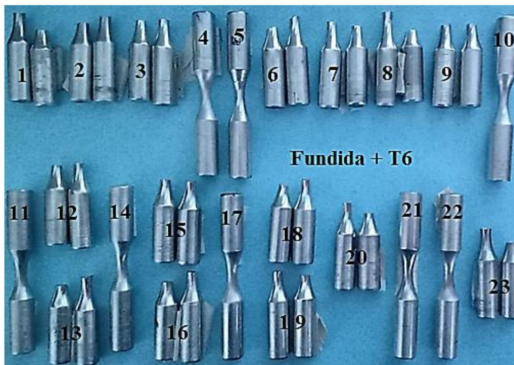
Figura A2 - Corpos de prova ensaiados na condição as cast+T6
