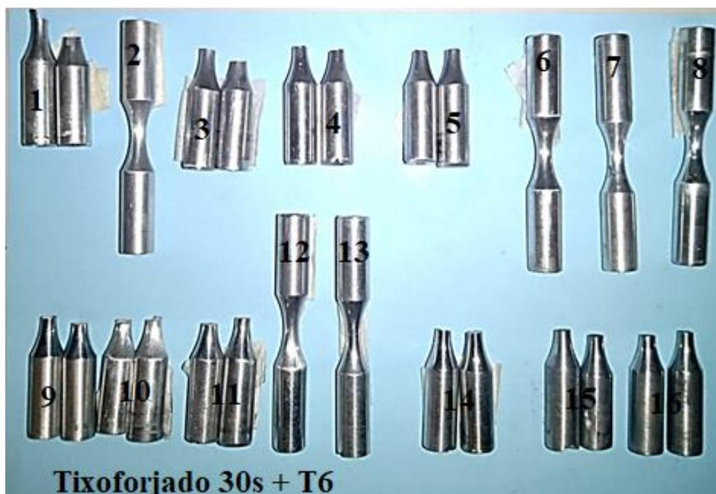
Figura A5 - Corpos de prova ensaiados na condição tixoforjados 30s+T6.
