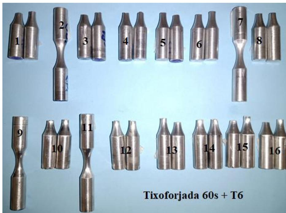
Figura A6 - Corpos de prova ensaiados na condição tixoforjados 60s+T6.
