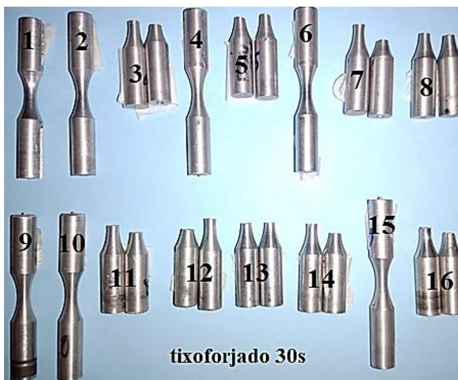
Figura A3 - Corpos de prova ensaiados na condição tixoforjados a 30s.
