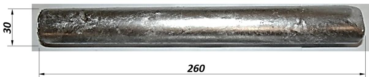
Figura 4.1 – Amostra de lingote produzido. Dimensões em mm.
