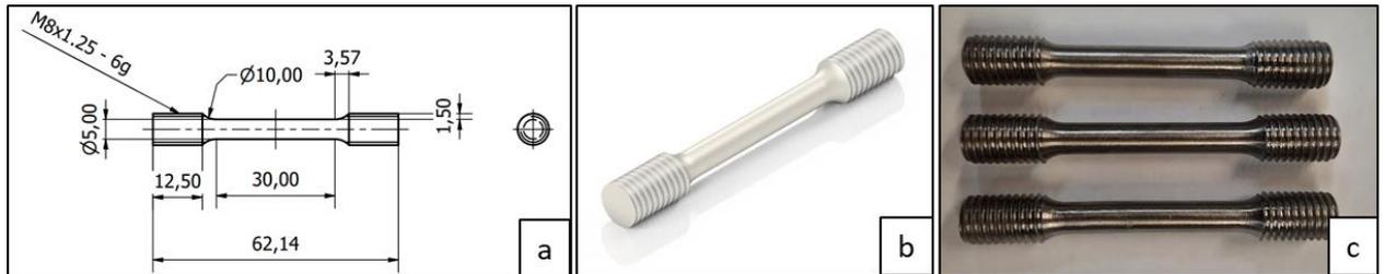
Figura 3.12. (a) Desenho do corpo de prova de tração; (b) Projeção do corpo de prova em 3D; (c) corpos de prova usinados
