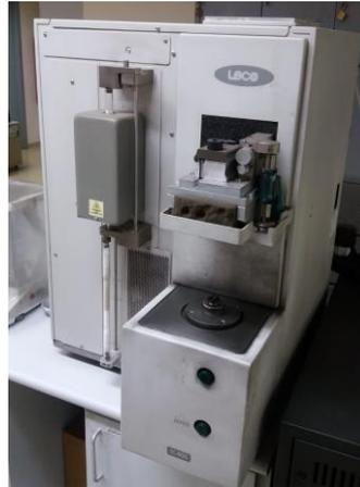
*Figura 3.8. Equipamento utilizado para medição dos teores de oxigênio e nitrogênio.*
