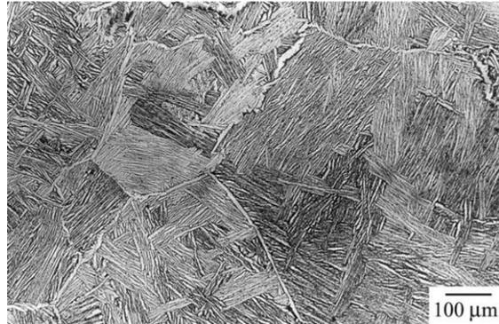
Figura 2.3. Microscopia ótica da liga Ti-6Al-4V solubilizada a 1020 °C/20 minutos e resfriada em forno mostrando a estrutura  $\alpha$  (Widmanstätten) (Ralph, 2008).
