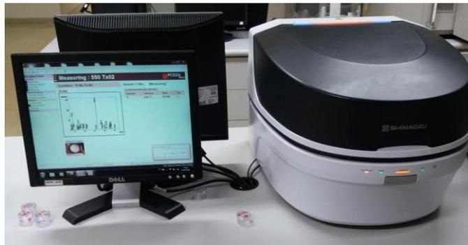
Figura 3.7. Equipamento de fluorescência de raios-X (Shimadzu EDX-7000).
