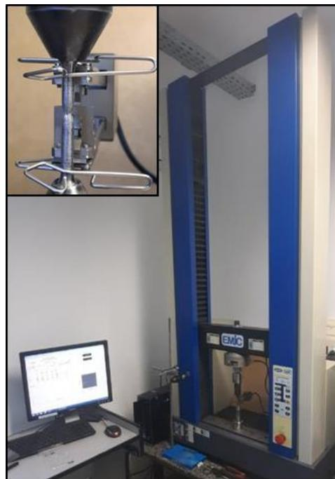
Figura 3.13. Máquina de Tração EMIC com célula de carga de 30 KN com detalhe de um corpo de prova sendo ensaiado.
