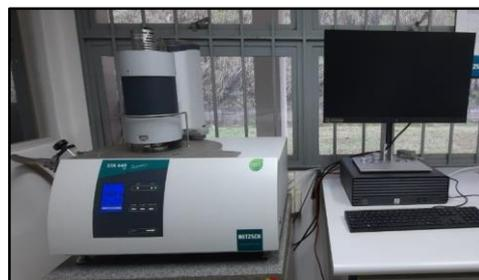
Figura 3.10. Analisador térmico NETZSCH STA 449F3
