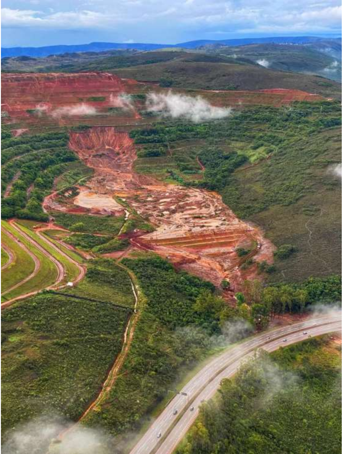
Figura 16: Vista parcial da Pilha Cachoeirinha após escorregamento próximo à BR 040, em Nova Lima (MG). Fonte: BARBATTI, 2022.)
