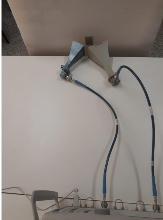
Figura 61: Medição do protótipo do tag na banda X.
