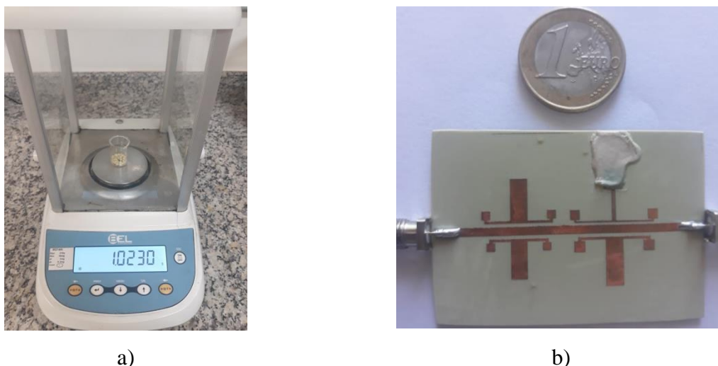
Figura 79: Retificação: a) pesagem do Stanyl e b) protótipo.
