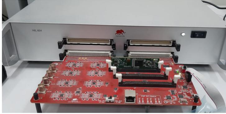
Figura 3.24 – Montagem para simulação com o HIL: Typhoon HIL 604, Typhoon  $\mu$ grid DSP interface, e o TMS320F28335.
