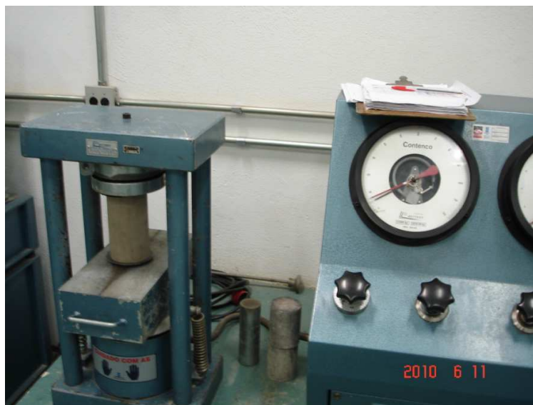
Figura 2: Ruptura dos corpos de prova à compressão.
