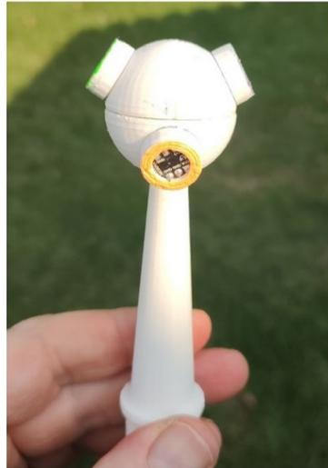
Figura 4.5 – Estrutura completa do arranjo tetraédrico projetado.
