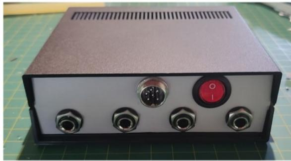
Figura 4.7 – Fotografia da caixa de conexões e fonte de alimentação regulada para microfones.
