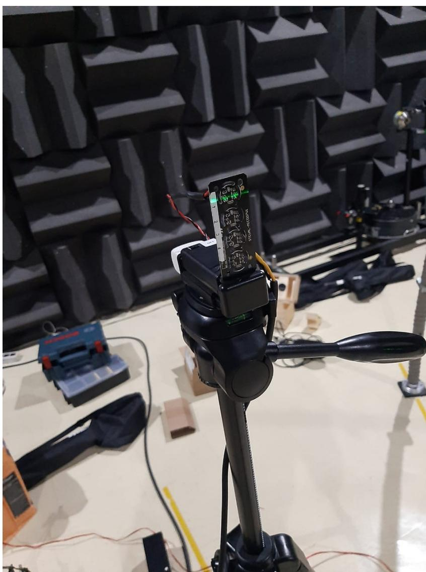
Figura 4.12 – Suporte auxiliar para a caracterização dos microfones. Fonte: Autor
