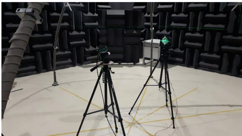
Figura 4.11 – Fonte e microfones posicionados para o ensaio em sala anecoica. Fonte: Autor
