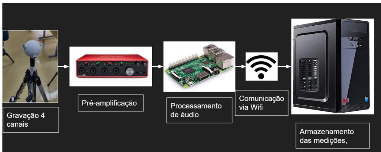
Figura 4.8 – Diagrama de funcionamento do sistema de captação acústica.
