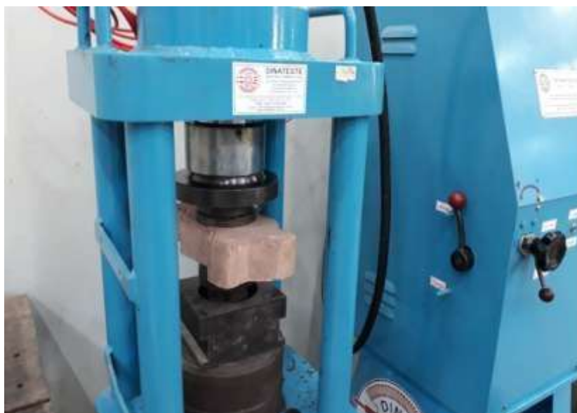
Figura 5 - Ensaio de compressão para os pisos intertravados (Fonte: o autor)
