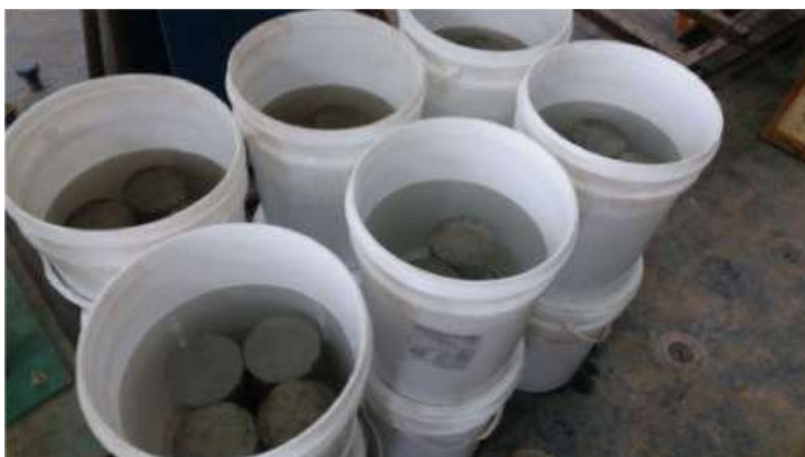
Figura 2 - cura dos corpos de prova cilíndricos (Fonte: o autor)
