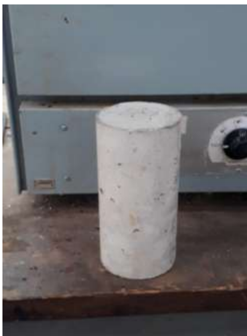
Figura 1 – Corpo de prova cilíndrico de 20 cm de altura e 10 cm de diâmetro (Fonte: o autor)
