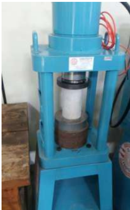
Figura 3 – máquina de ensaio de compressão dos corpos de prova cilíndricos (Fonte: o autor)
