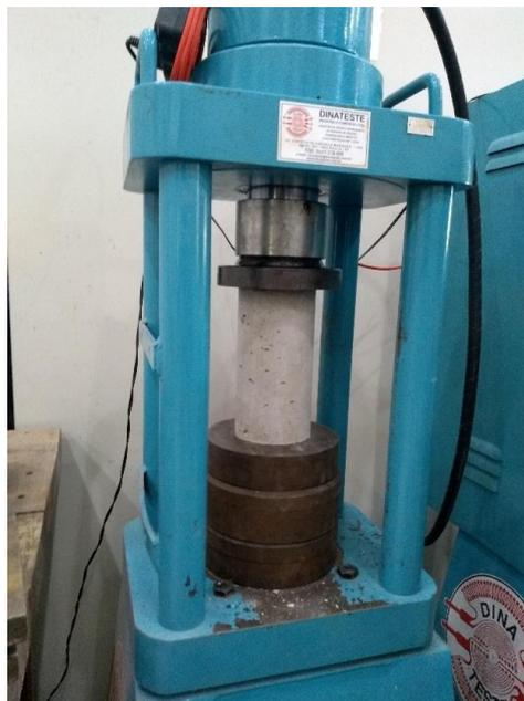
**Figura 16.** Corpos de prova após a ruptura em prensa hidráulica. Fonte: Acervo pessoal.
