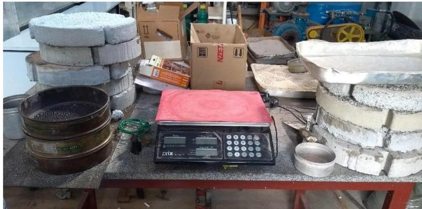
**Figura 21.** Medição da massa para corpo de prova na situação de saturação inicial. Fonte: Acervo pessoal.
