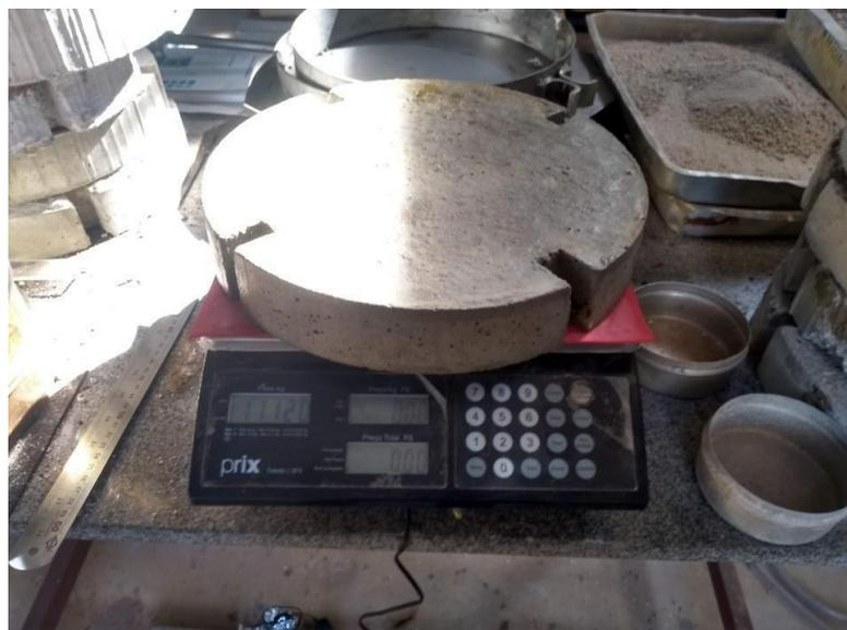
Em termos dos resultados obtidos, as Figuras 22 e 23 apresentam o gráfico de perda de massa relativa das amostras ensaiadas, ou seja, a relação entre a massa aferida em dado instante do ensaio e a massa original da amostra em estado saturado. Já a Tabela 3 detalha todas as aferições realizadas, em quilogramas.
