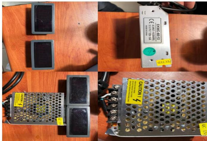
figura 65 - Fonte e visor para a leitura das velocidades de rotação dos conjuntos da TEiiM
