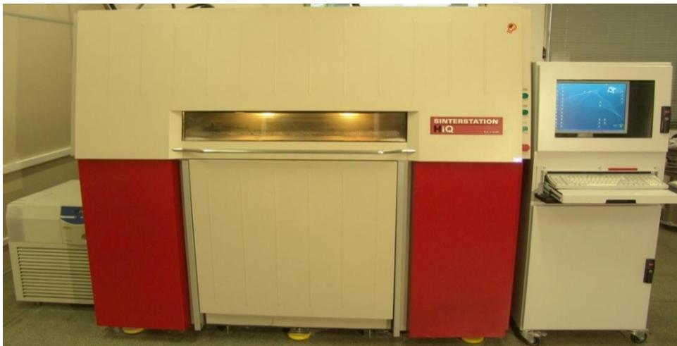
figura 47 - Impressora 3D modelo Sinterstation 2000
