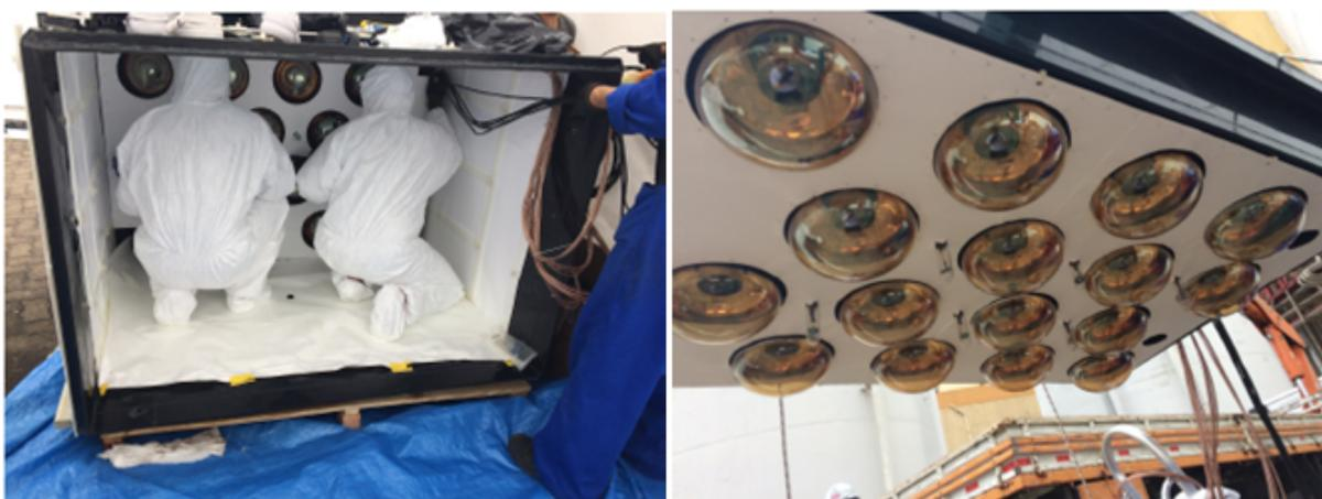
Figura 2.3: Montagem das PMTs no *target* do detector. Esquerda: instalação na base do tanque-alvo. Direita: 16 fotomultiplicadoras instaladas na tampa (topo) do tanque-alvo. (J.A.M. AFONZO, 2019)
