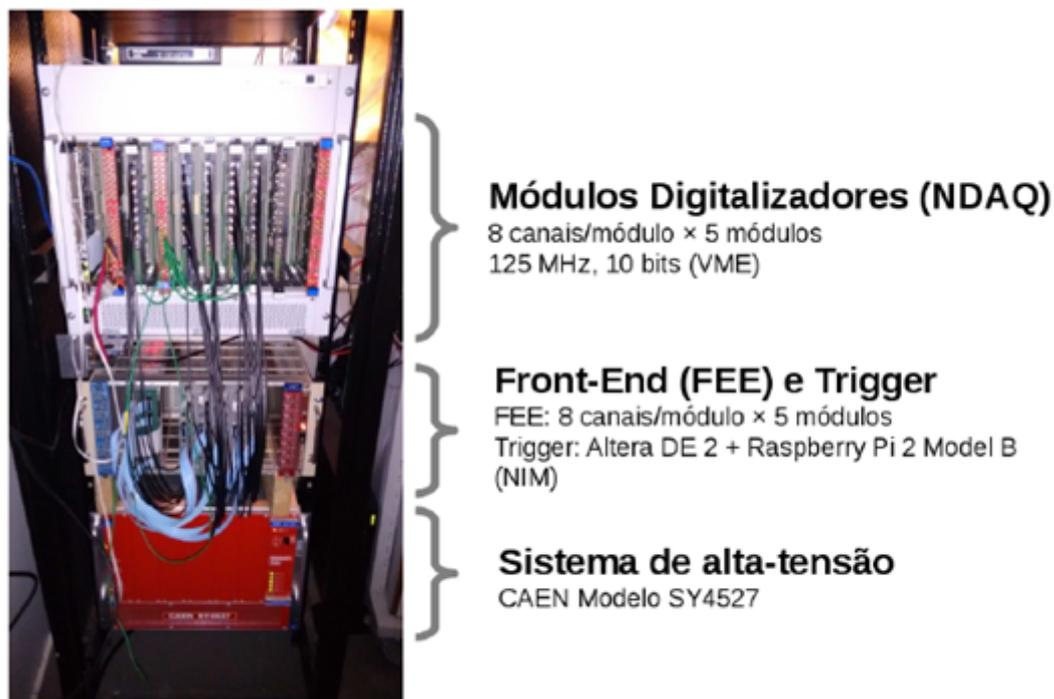
Figura 2.4: Rack com os módulos de aquisição de dados do experimento  $\nu$ -Angra (GONZALEZ, 2019)
