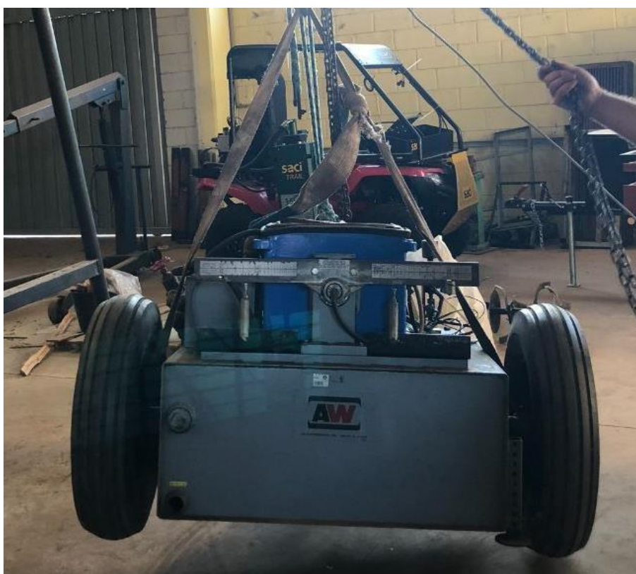
Figura 2: dinamômetro de freio hidráulico modelo AW NEBRASKA 400®
