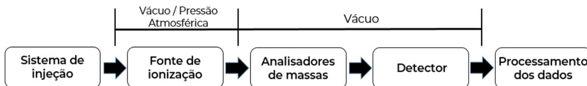
**Figura 1.2.** Representação esquemática de um espectrômetro de massas. Analisadores de massas podem ser simples (somente um analisador de massas) ou híbridos (contendo dois - ou mais - analisadores de massas, com uma célula de colisão entre eles) e, em alguns casos, o detector pode estar localizado junto com o analisador (como é o caso de analisadores baseados em transformada de Fourier, como Orbitrap e ressonância ciclotrônica de íons).
