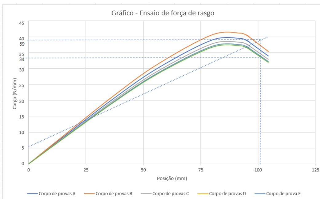
**Figura 76:** Gráfico do ensaio força de rasgo
