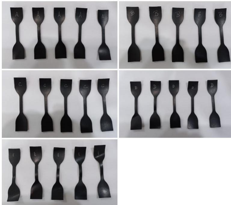
**Figura 53:** Corpos de prova resistência à tração e alongamento
