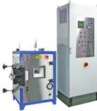
**Figura 28:** Forno de pós cura microondas
