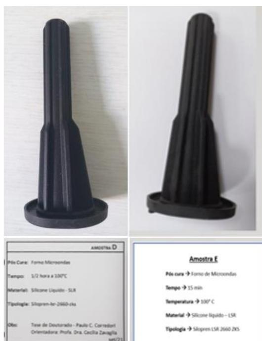
**Figura 68:** Amostras pós cura no forno microondas
