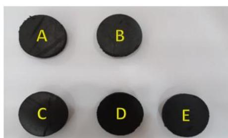
**Figura 62:** Corpos de prova de ensaio de dureza
