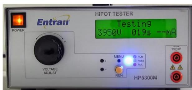
**Figura 69:** Equipamento de ensaio de rigidez dielétrica
