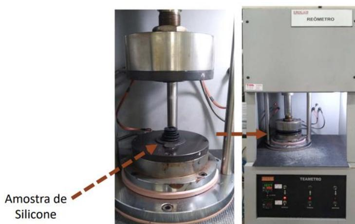
**Figura 66:** Fotos do reômetro utilizado nos ensaios
