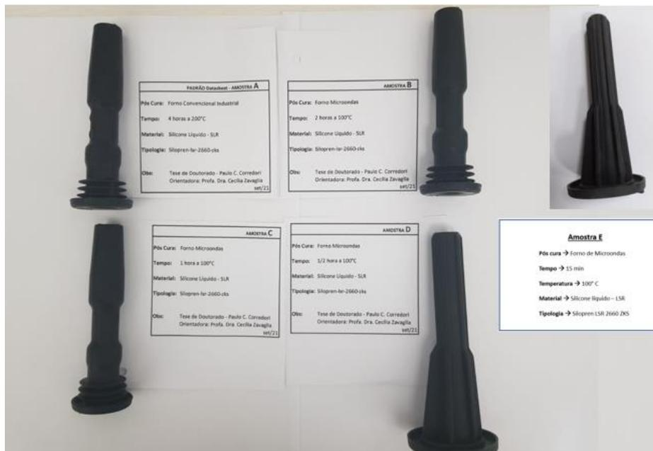
**Figura 47:** Amostras funcionais pós-curadas no forno microondas
