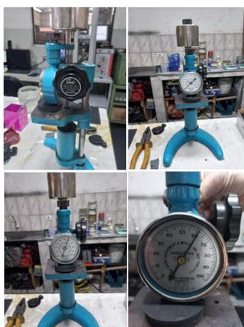
**Figura 63:** Ensaio de dureza
