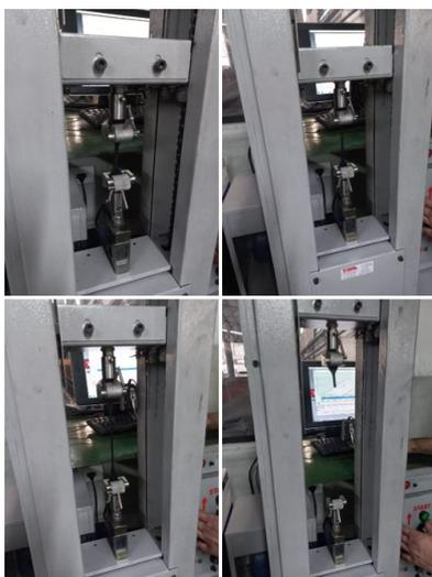
**Figura 54:** Teste de tração conforme DIN 53504 S2
