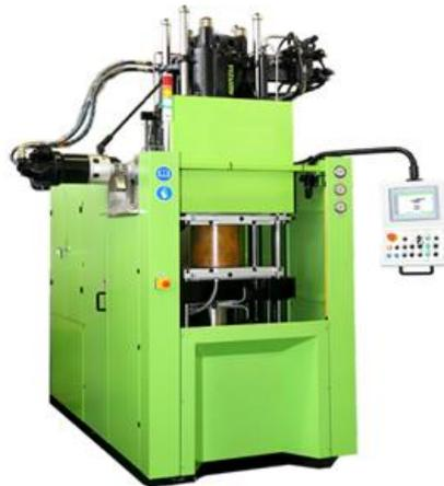
**Figura 18:** Injetora do tipo prensa vertical
