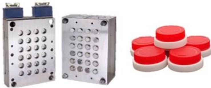
**Figura 19:** Molde de injeção de injetora horizontal
