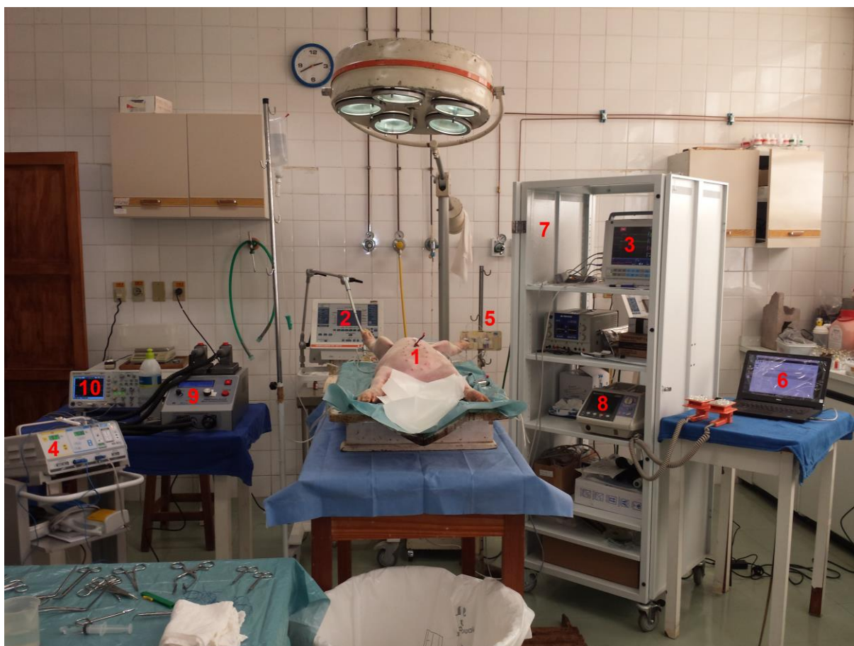
Figura 3.22 – Setup experimental montado para os testes do desfibrilador multidirecional transtorácico. Na figura estão representados: 1 modelo experimental suíno, 2 ventilador pulmonar DX 3010, 3 monitor multiparamétrico Procure B20, 4 bisturi eletrônico SS-501, 5 transdutor de pressão TruWave , 6 computador com o software de aquisição iCollect , 7 armário de aço VLFA-55, 8 desfibrilador-cardioversor TEC-5531B, 9 desfibrilador multidirecional transtorácico, 10 osciloscópio digital DSO1004A. Ver texto a seguir para detalhes.
